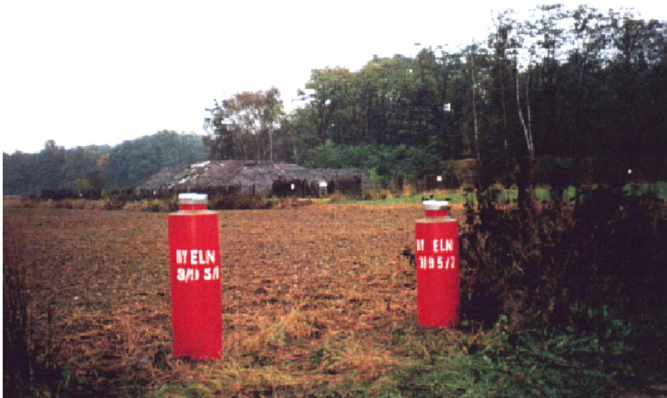
**Abb. 7.4.1: Grundwassermessstellen anstromig einer u.a. zum Verbrennen von Produktionsrückständen genutzten Fläche**
