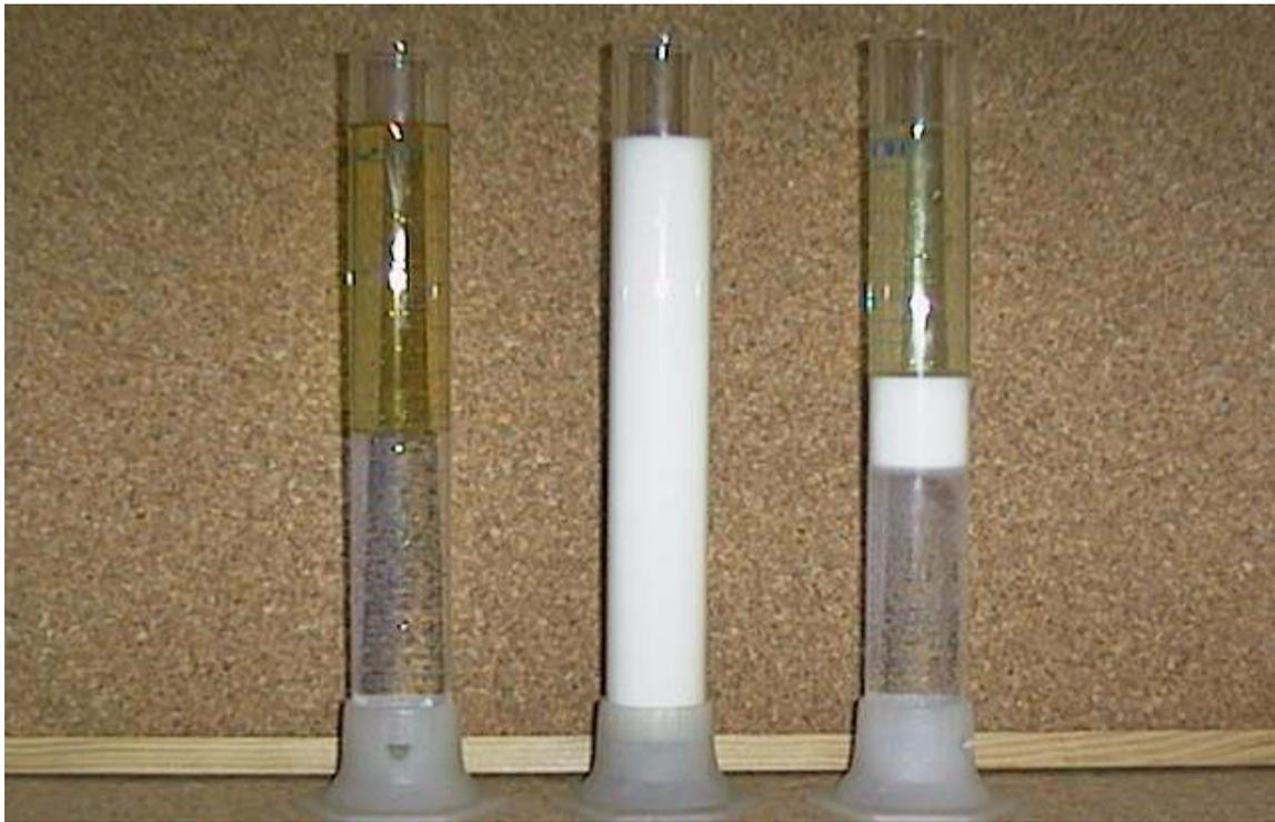
**Abb. 1: Modellzylinder mit 2-Phasen-System Diesel-Wasser (links), stabiler Diesel-Wasser-Emulsion (Mitte) und 3-Phasen-System Diesel-Emulsion-Wasser (rechts)**
