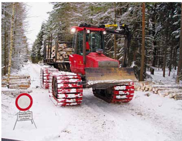
Bild 10.10: Rückung mit Forwarder – Boogiebänder dienen der Minimierung des Bodendrucks
