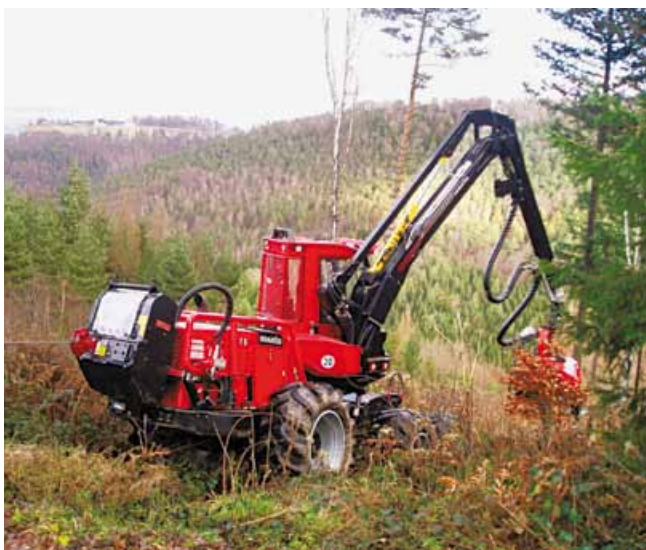
Bild 10.9: Harvester der Maschinenstation Königstein im schwierigen Gelände mit Unterstützung durch Traktionswinde
