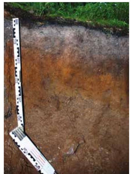
Abb. 3: Bodenprofil auf der Dauerbeobachtungsfläche Klingenthal (Podsol)
