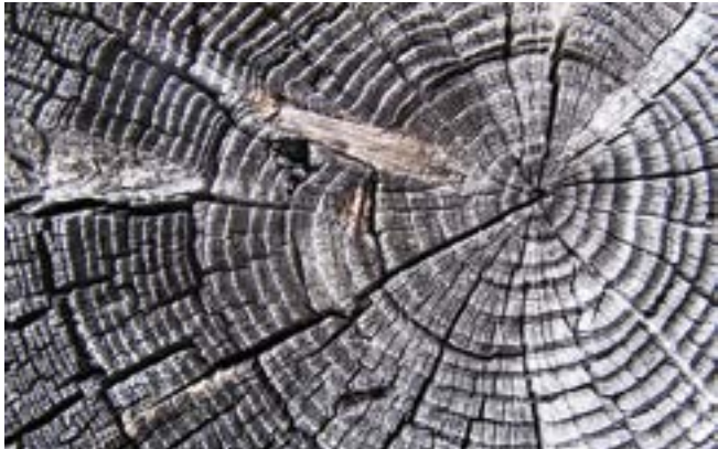
Holz hat sich selbst als Dachbedeckung und Wandverkleidung bewährt und trotz so Jahrzehntelang Wind und Wetter, hier am Jugendzentrum Leipzig-Gohlis (links). Charakteristische, verwitterte Holzoberfläche, die statischen Eigenschaften beeinträchtigt dies nicht (oben).
