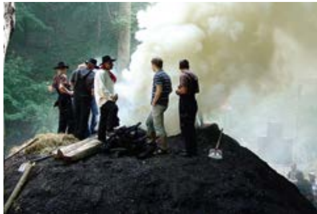
Holz als Energielieferant bei der Holzkohleherstellung. In der hier dargestellten historischen Form beim jährlichen Meilerfest in Tharandt wird die Holzkohleherstellung nur noch sehr selten praktiziert.
