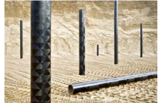
So könnte es bald häufiger auf Baustellen aussehen. Formholz als Träger-elemente (oben). Die stolzen Entwickler neben ihren Formholzröhren (rechts)
