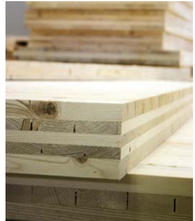
Brettsperrholz in Nahansicht. Deutlich zu erkennen ist die kreuzweise Anordnung der einzelnen Brettlagen.
