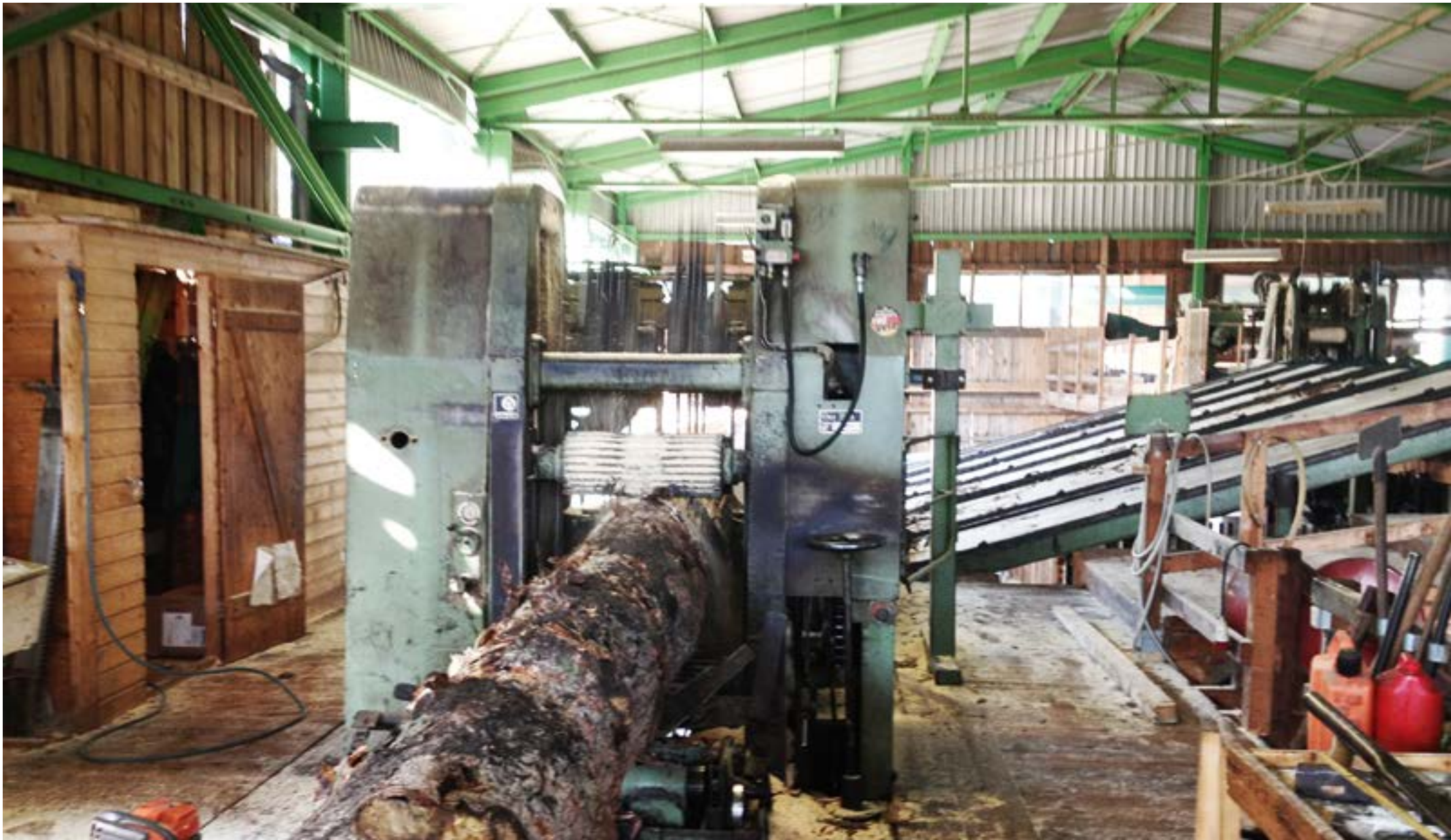
Bandsägegatter eines kleineren Sägewerkes.
