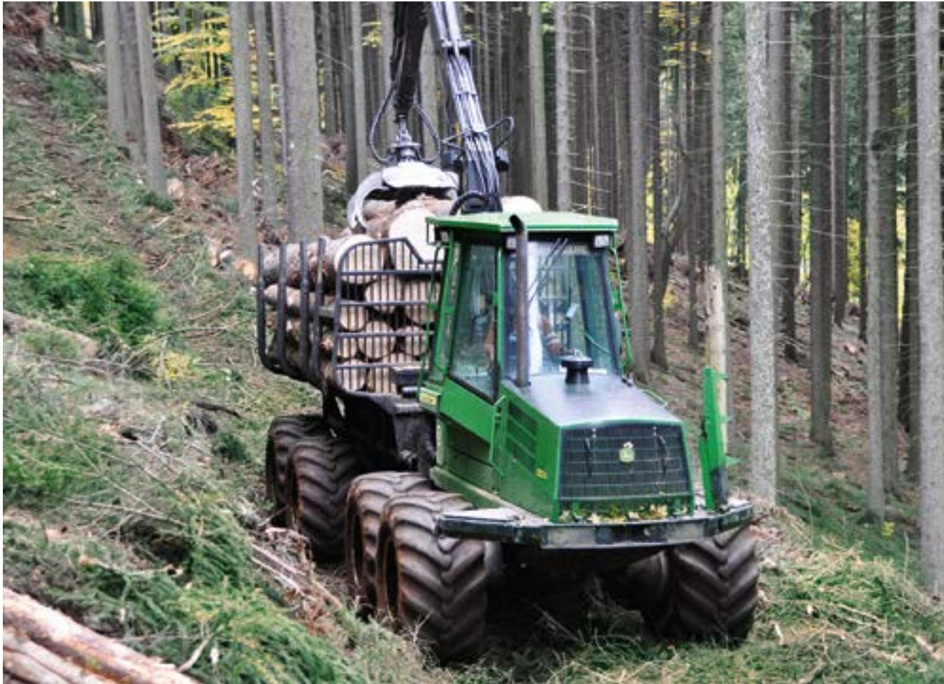
Holzrückung mittels Tragschlepper.
