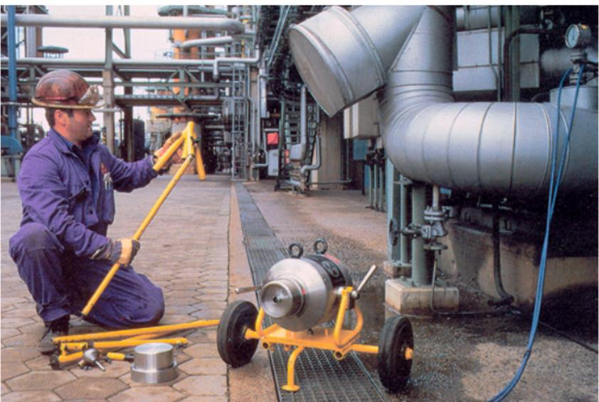
Untersuchungen von Rohren mittels radioaktiver Strahlung
