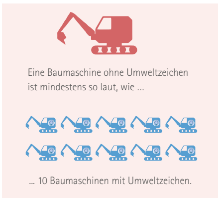
Abb. 8: Geräuschabstrahlung von herkömmlichen im Vergleich zu lärmarmen Baumaschinen
