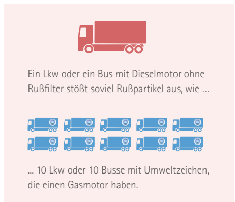
Abb. 9: Partikelstoß von dieselgetriebenen (ohne Rußfilter) im Vergleich zu gasgetriebenen Lkw oder Bussen
