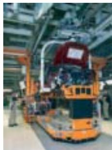
*Сборка автомобилей на заводе фирмы Volkswagen в Цвикау/Мозеле*
