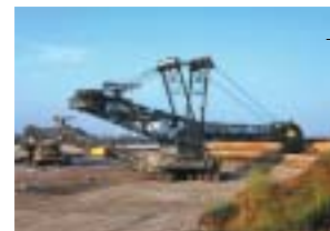
Excavateur de déblais sur le chantier à ciel ouvert de Nochten
