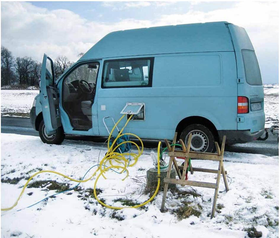
Grundwasserprobennahme mit einem Probennahmefahrzeug der BfUL
