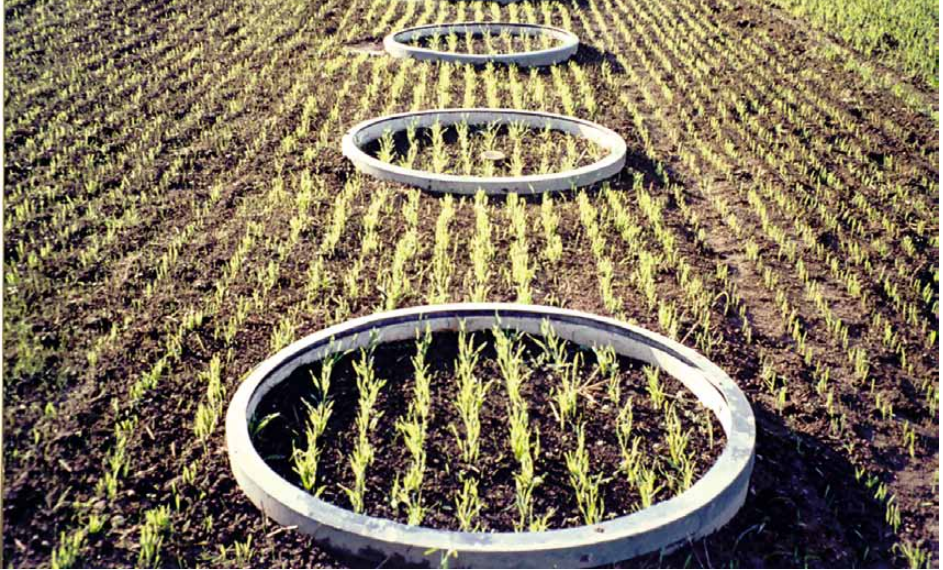
Wägbare Lysimeter am Standort Brandis bei Leipzig
