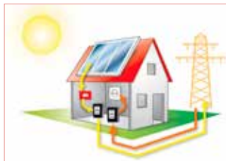
Abb. 11: Netzgekoppelte Anlagen [ARGE SOLAR]
