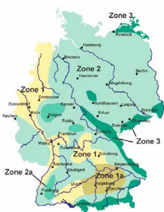
Abb. 16: Unterschiedliche Schneelastzonen in Deutschland [wikipedia]
