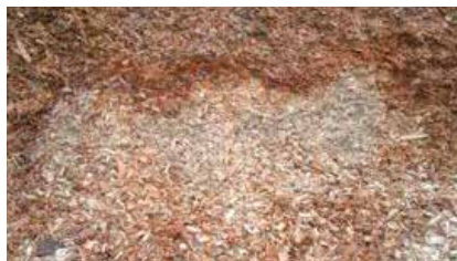
Abb. 46: Kondensationsband in einem HHS-Haufen [Zimmermann u. Wern 2004]
