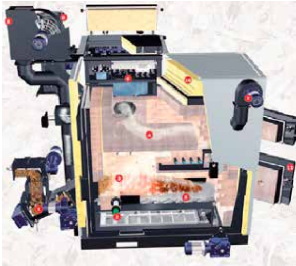
Abb. 63: Schematische Darstellung einer Vorschubrostfeuerung [FRÖ 2011]
