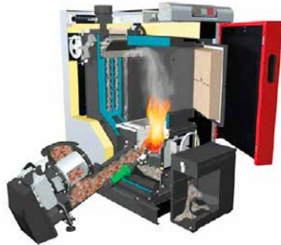
Abb. 61: Schematische Darstellung einer Unterschubfeuerung [FRÖ 2011]
