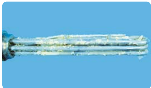
Kalkablagerung an Heizstäben
