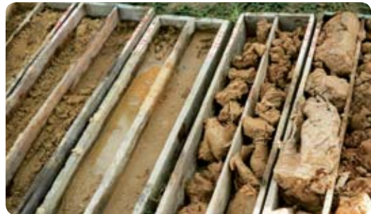
Der Bohrkern gibt Hinweise auf die genaue Lage von durchlässigen und nicht durchlässigen Schichten.
