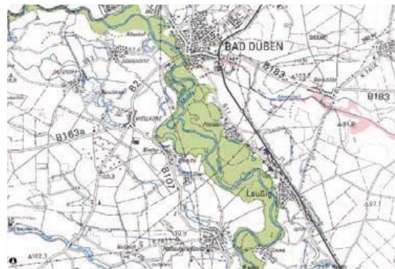
Abb. 3: Festgesetztes Überschwemmungsgebiet HQ 100 der Vereinigten Mulde bei Bad Dübener Heide (Quelle: Internet LfUG)
