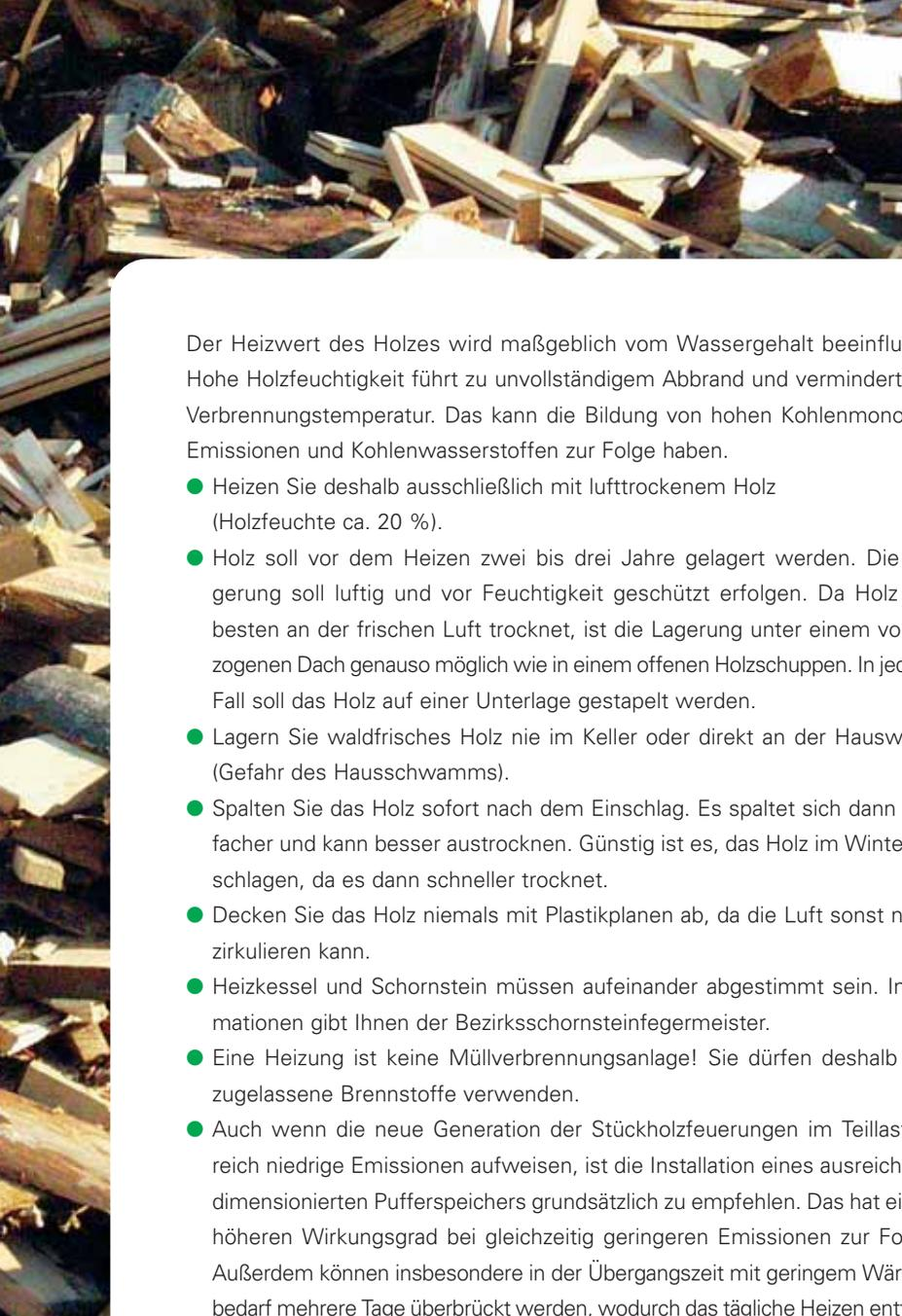
Der Heizwert des Holzes wird maßgeblich vom Wassergehalt beeinflusst. Hohe Holzfeuchtigkeit führt zu unvollständigem Abbrand und vermindert die Verbrennungstemperatur. Das kann die Bildung von hohen Kohlenmonoxid-Emissionen und Kohlenwasserstoffen zur Folge haben.
