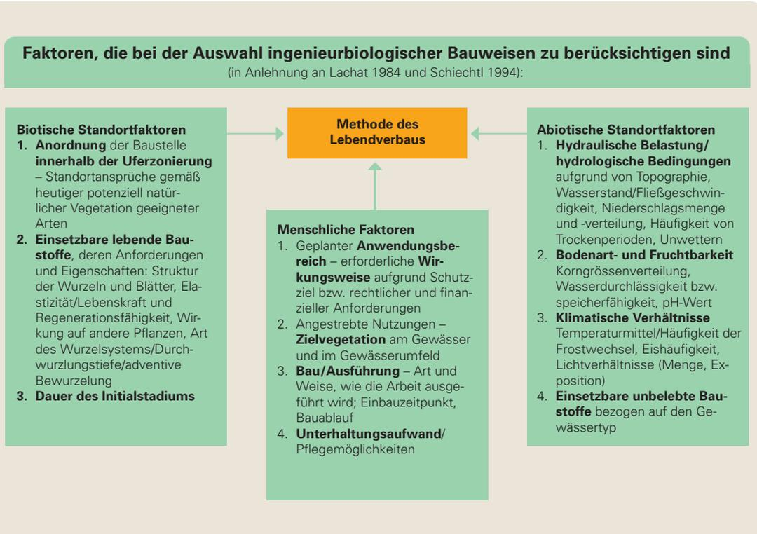
Abb. 2: Faktoren für die Auswahl ingenieurbioologischer Bauweisen (Quelle: Stowasser)
