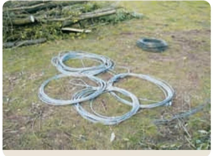
Bild 2.6.3.1: Stahlseile, 12 mm stark zur Befestigung von Raubäumen, beglühter Draht, 3 mm stark zum Binden von Faschinen
