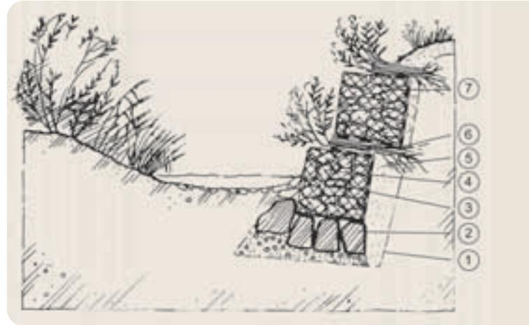
Abb. 3.4.3.8: Begrünte Gabionen als Stützbauwerke zur Böschungfuß- und Ufersicherung, Querschnitt (Quelle: Stowasser)
