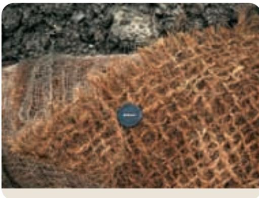
Bild 3.4.3.2: 2-lagige Böschungsschutzmatten zur Verhinderung von Ausspülungen unterhalb der Matte
