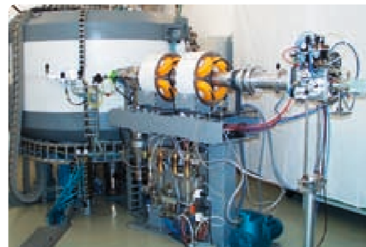
Zyklotron zur Erzeugung künstlicher radioaktiver Stoffe
