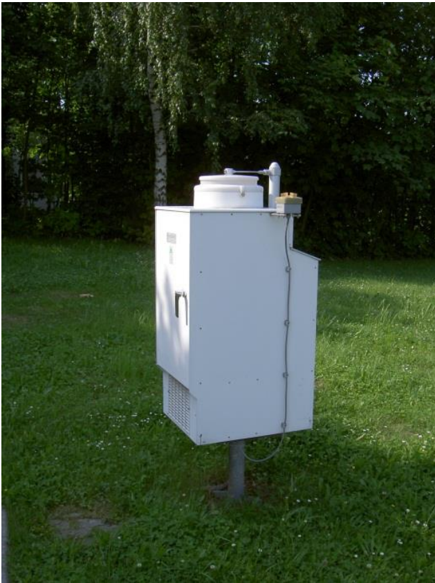
Abbildung 39: Eigenbrodt-Sammler zur Bestimmung der nassen Deposition
