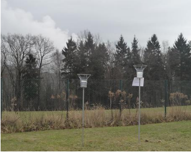
Abbildung 38: Probenahmegefäß für Staubniederschlagsmessungen (Bergerhoff-Sammler)
