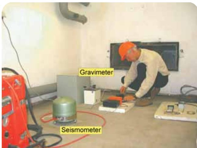
**Abb. 29:** Messkammer für seismische und Gezeitenregistrierung
