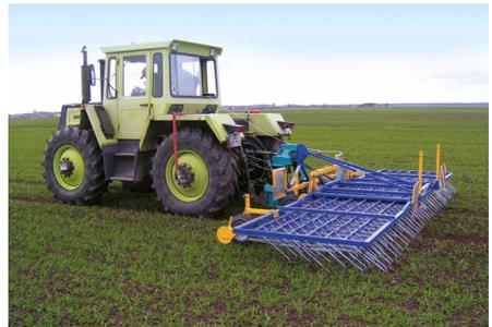
oben: Regenwurm; unten: mechanische Unkrautregulierung mit dem Striegel im Getreide
