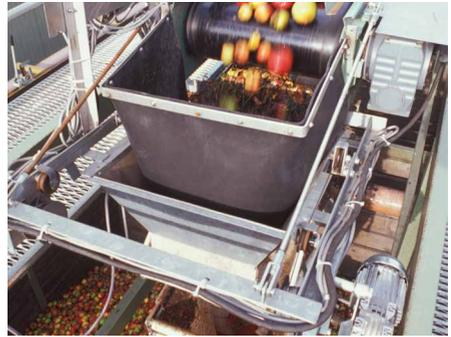
Förderanlage mit Äpfeln zur Herstellung von Saft
