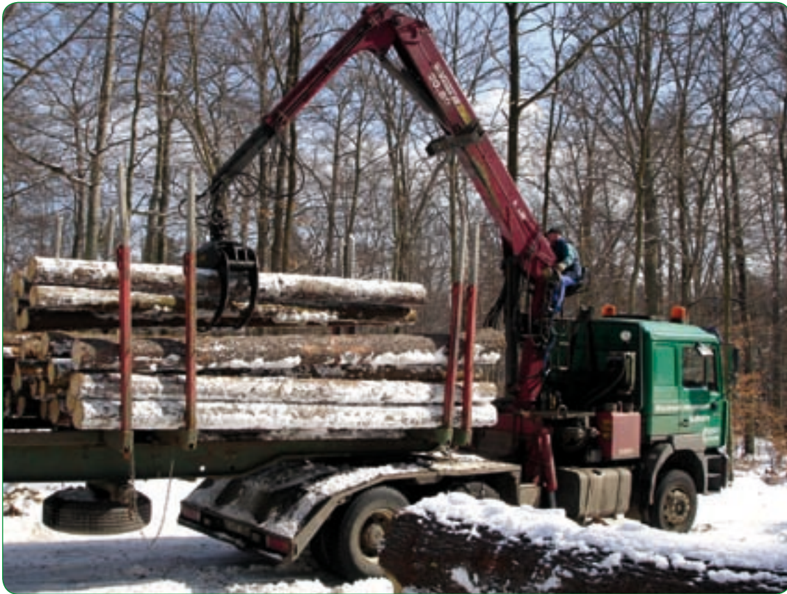
Bild 4.5: Transport von Fichten- stammholzabschnitten
