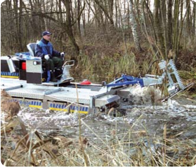
Abb. 89: Schilfschnitt mit der amphibischen Universalmaschine TRUXOR.
