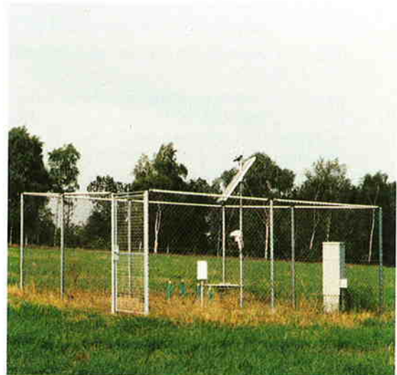
■ Abb. 7.4.4: Automatische Bodenmeßstation Hilbersdorf (BDF II) im Immissionsbereich der Freiburger Metallhütten
