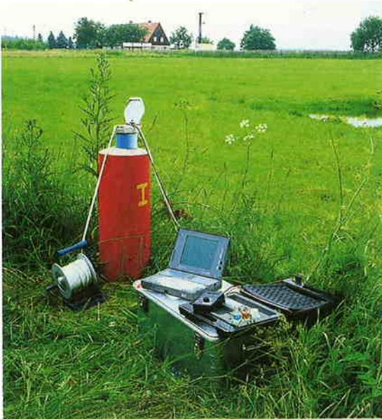
■ **Abb. 3.2.2: Grundwassermeßstelle, Messungen an einem hydrologischen Aufschluß**
