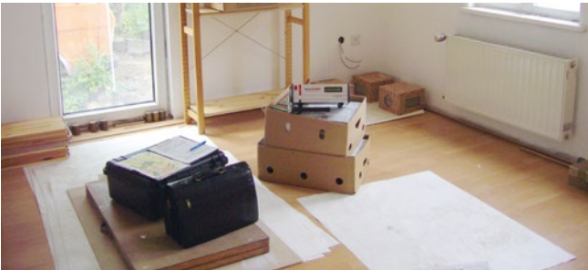
Radonmessung mit einem Radonmonitor in einem Neubau
