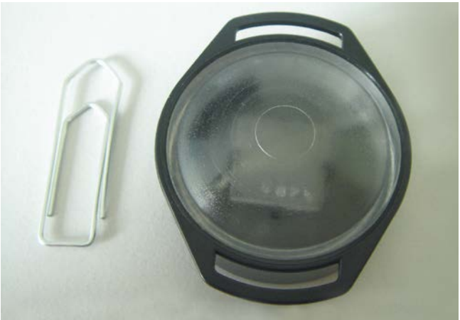
Kernspurdetektor zur Messung von Radon in Innenräumen über Zeiträume bis zu einem Jahr.
