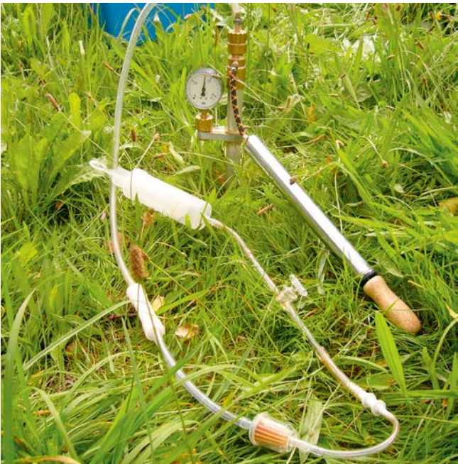
Beprobung der Bodenluft mit einer 1 Meter-Packersonde zur Ermittlung der Radonkonzentration in der Bodenluft.
