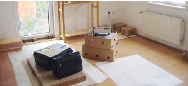
Radonmessung mit einem Radonmonitor in einem Neubau
