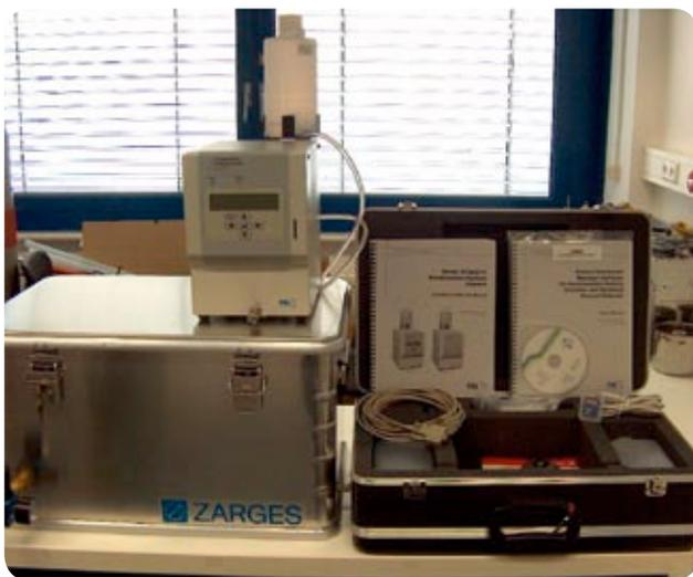
Bild 5.4.3-1: Mobiler Aerosolstandard mit Aerosolerzeugungseinheit (links), Kondensationskernzähler TSI 3772 (oben) und Zubehörkoffer (rechts), Foto: IFT
