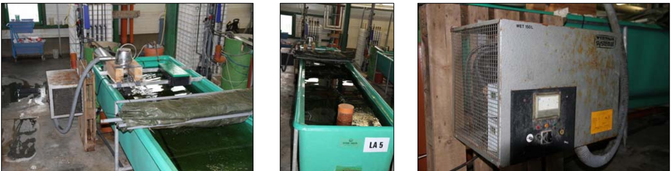
Abbildung 3: Kühlgerät Westfalia WET 150L (Leistung 1,5 KW) in Langstromrinne mit HSB-F2
