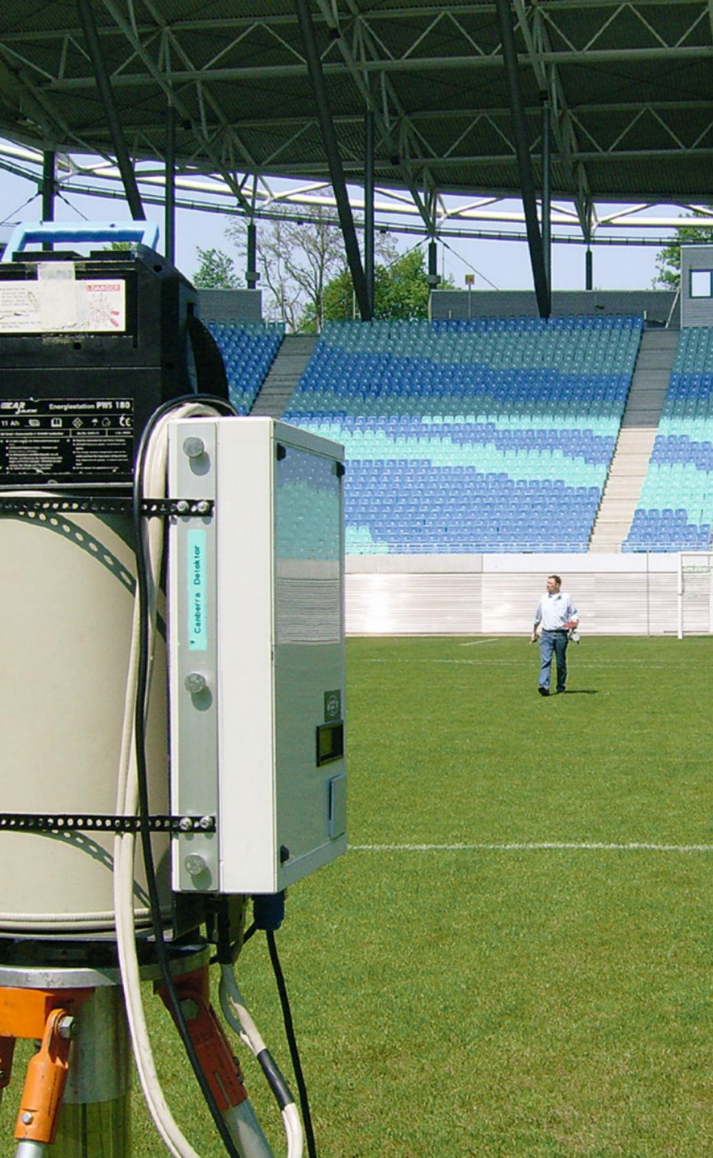
Ermittlung der Umgebungsstrahlung mit einem mobilen Messgerät in einem Fußballstadion
