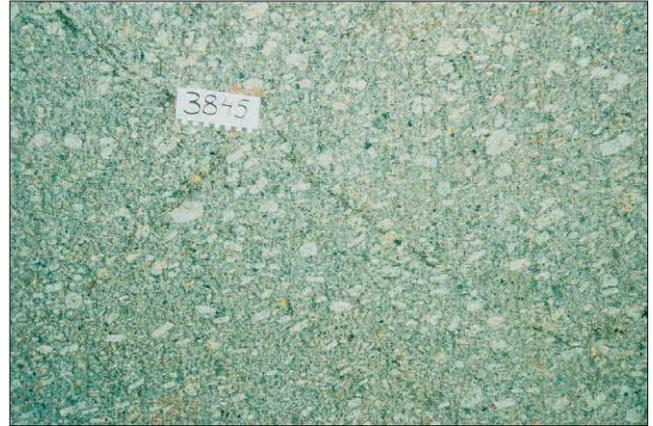
Abb. 11: Station 3845 m - Fließgefüge im Granittyp 3; Maßstab in Zentimetereinteilung
