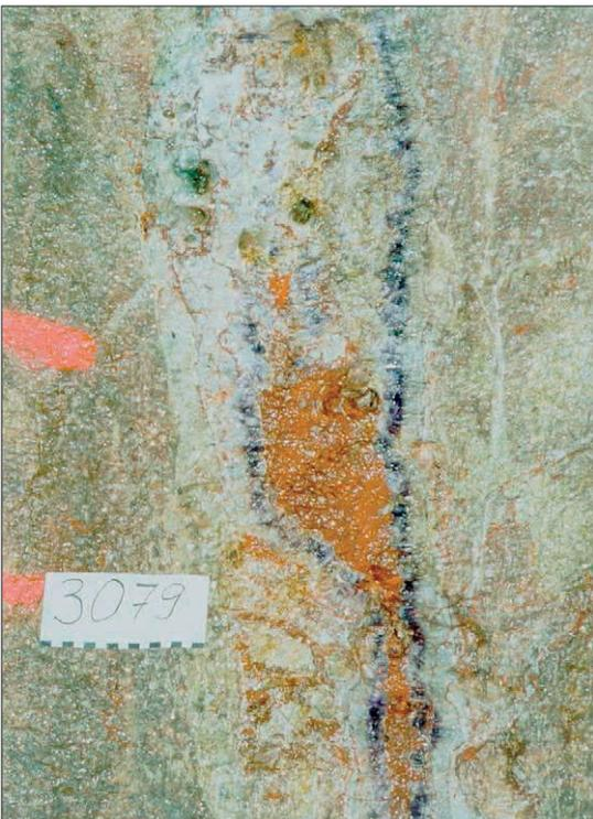
Abb. 14: Station 3079 m - Quarzgang mit Amethyst-Salbändern und zentraler Jaspisfüllung im Granittyp 3; Maßstab in Zentimetereinteilung
