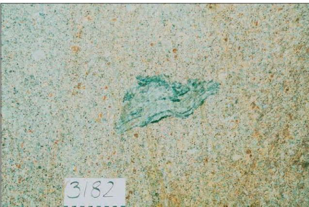
Abb. 12: Station 3182 m - hornfelsartiger gefalteter Xenolith im Granittyp 4; Maßstab in Zentimetereinteilung
