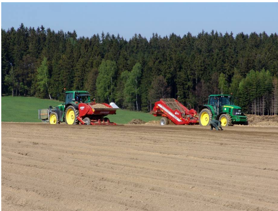
Abbildung 13: Separierung des Bodens und Legen der Kartoffeln in aufeinander abfolgenden Arbeitsgängen
