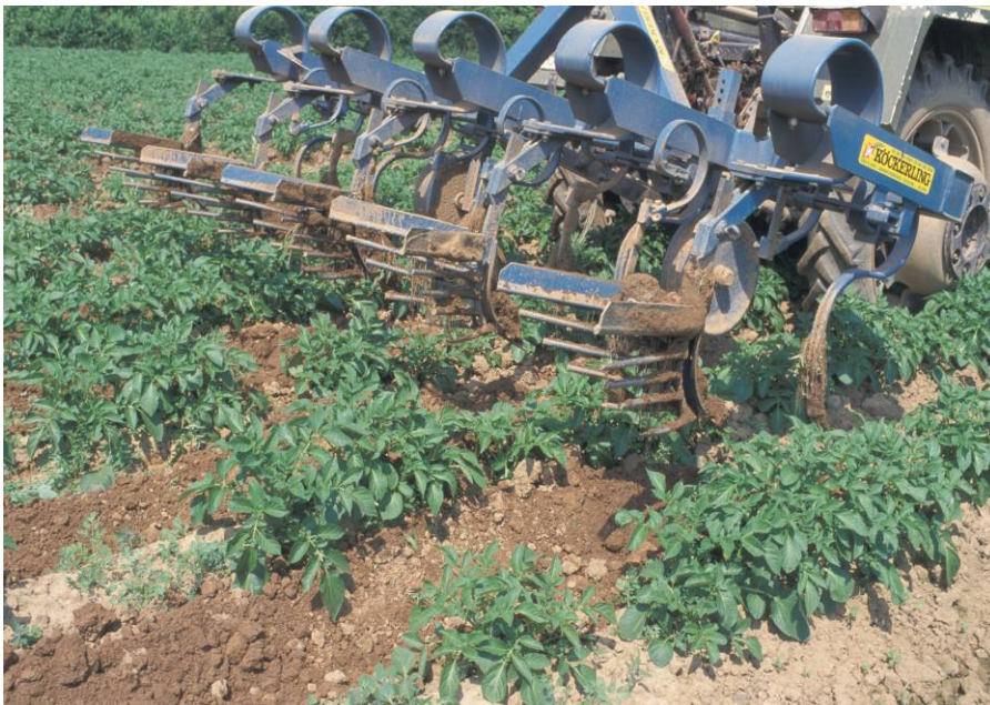
Abbildung 14: Einsatz des Häufelstriegels in Kartoffeln
