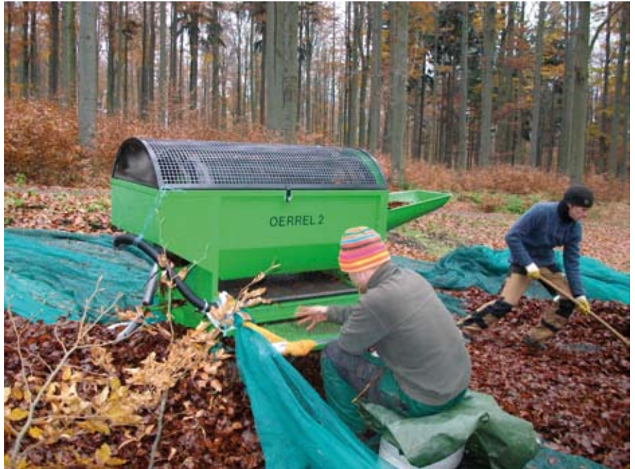
Abb. 11: Ernte von Buckeckern und Trennung des Rohsaatgutes von Laub und anderen Verunreinigungen mit der Saatgutaufarbeitungsmaschine Oerrel
