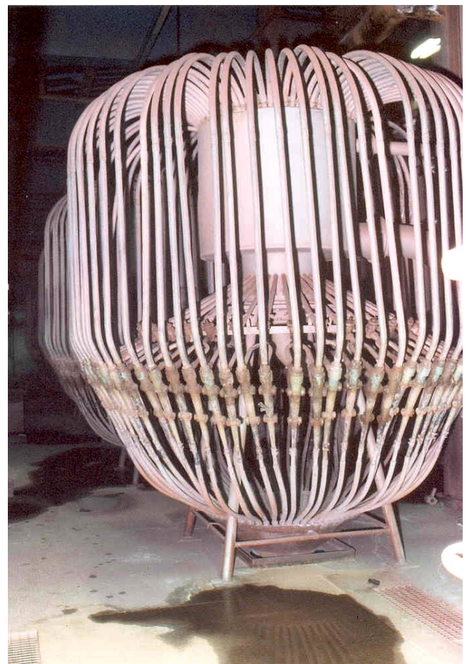
Abb. 164: Neue Flotation, Hydrozyklone im Rundverteiler Foto: H. LAUSCH
