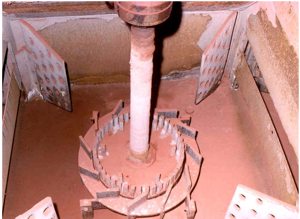
Abb. 161: Blick in eine 6 m 3 Flotationszelle mit Fingerrührer Foto: H. LAUSCH
