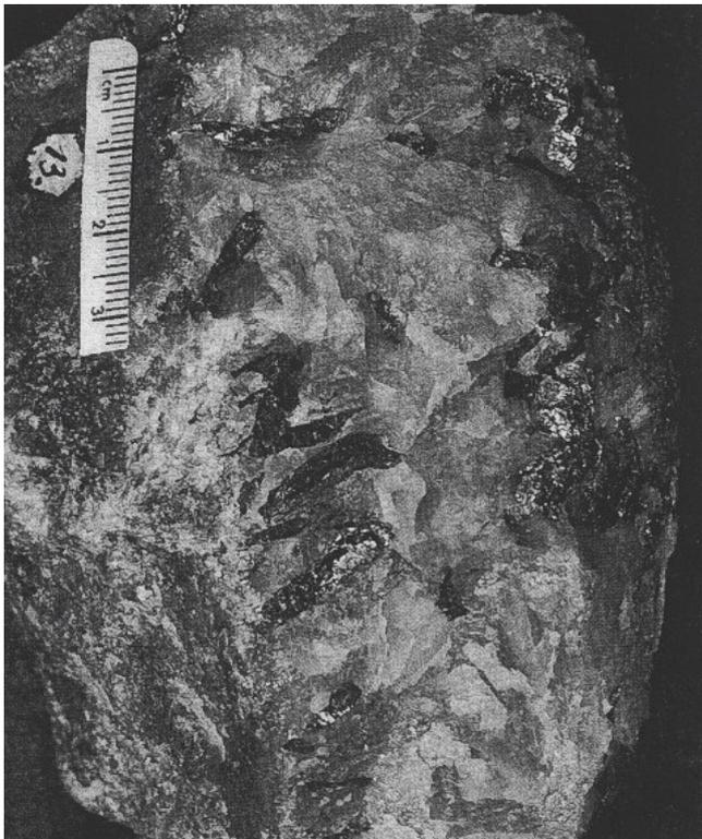
Abb. 55: Quarzgang mit Wolframit und Molybdänit – Paragenesetyp 4 – im QTZ 4. Sohle
