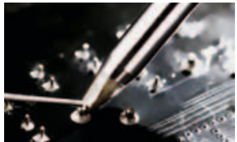
Mit Zinn eingelötete Bauelement-Anschlüsse
