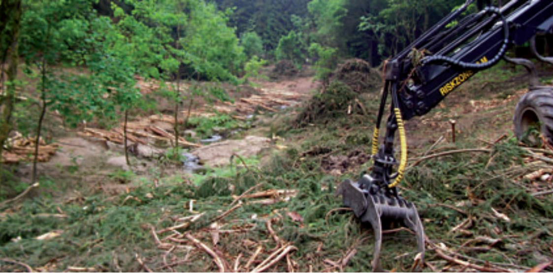
Abb. 4: Der Harvestergreifarm nimmt Reisig auf. Foto: A. Clauß
