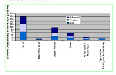
Aus den Radionuklidkonzentrationen und den effektiven Dosisleistungen lässt sich abschätzen, ob das Material für den Bau von Wänden oder als Oberflächenbelag (Fliesen o.ä.) geeignet ist.
