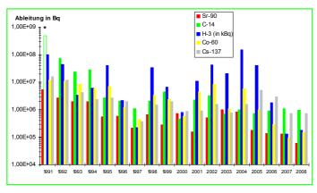
Die Ableitungen von Radionukliden mit dem Abwasser bzw. der Abluft zeigen seit der Außerbetriebnahme der kerntechnischen Anlagen am 31.12.1991 eine leicht rückläufige Tendenz bzw. sind nahezu konstant. Geringfügige Anstiege der Ableitungen einzelner Radionuklide sind mit der zunehmenden Rückbautätigkeit aufgrund vorliegender Stilllegungsgenehmigungen zu erklären.
