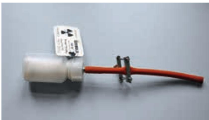
Vorrichtung mit Thoriumpulver (110 kBq) mit Bauartzulassung (BAZ) NW 6/65
