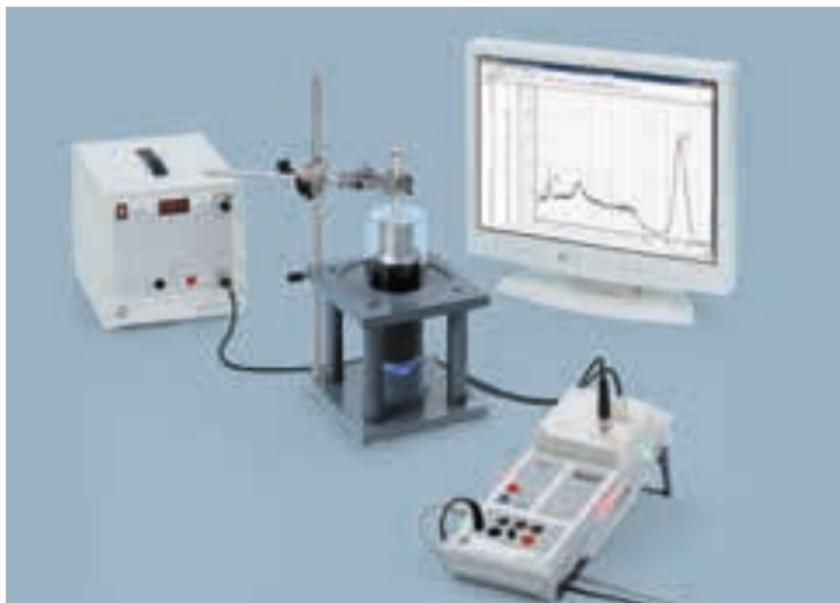
Experimentelle Anordnung zum Nachweis von  $\gamma$ -Strahlung mit einem Szintillationszähler; Foto: LD Didactic GmbH
