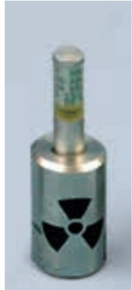
Abb. links: Strahlersatz mit Am-241 (74 kBq), Co-60 (74 kBq), Sr-90 (74 kBq), Na-22 (74 kBq), Mischpräparat Cs-137/Am-241/Sr-90 (333/4,44/4,44 kBq); mit ehemaliger BAZ Nds 002/99; Anzeigepflichtige Verwendung des Strahlersatzes möglich, sofern der Umgang vor dem 31.10.2009 beim LfULG angezeigt wurde. Für später erworbene Vorrichtungen ist eine Umgangsgenehmigung erforderlich.
