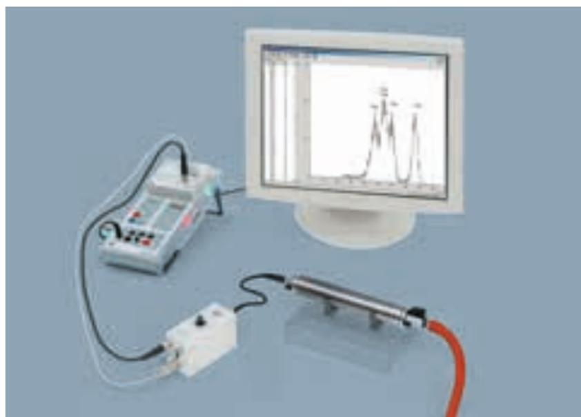
Experimentelle Anordnung zur  $\alpha$ -Spektroskopie an radioaktiven Proben
