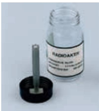
Ra-226-Präparat (3,3 kBq); Freigrenzenpräparat mit BAZ NW 229/81; Werden mehrere dieser Präparate angeschafft, ist aufgrund der Bauartzulassung der Umgang oberhalb der Summenformel anzeigepflichtig.
