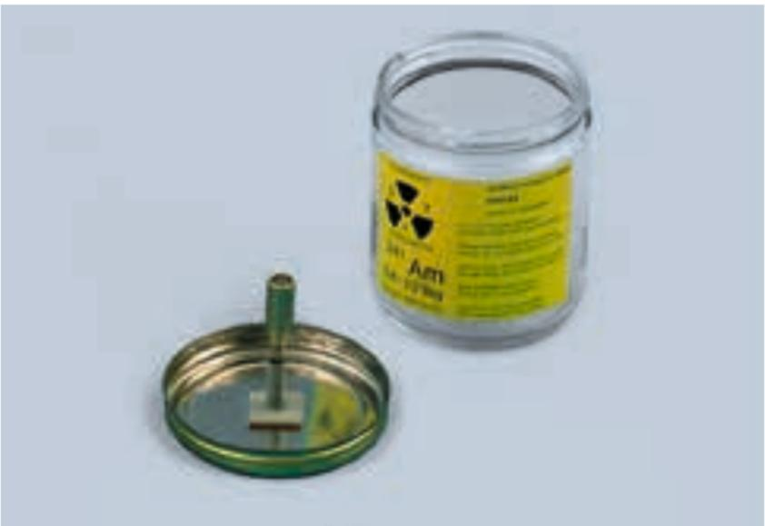
Am-241-Präparat (330 kBq); mit ehemaliger BAZ NW 76/76; Anzeigepflichtige Verwendung des Strahlers möglich, sofern der Umgang vor dem 23.03.2009 beim LfULG angezeigt wurde. Für später erworbene Vorrichtungen ist eine Umgangsgenehmigung erforderlich.
