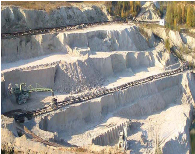
Abb. 67: Tagebau Gröppendorf, Kaolingewinnung mit Schaufelradbagger
