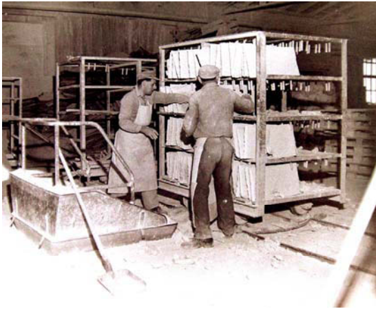
Abb. 71: Entleeren der getrockneten Filterkuchen in einen Brecher
