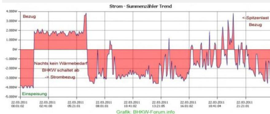
**Abbildung 6: Exemplarische Betriebsweise eines wärmegeführten BHKW ( $P_{el} = 6 \text{ kW}$ ) aus BHKW-Forum [2012]**
