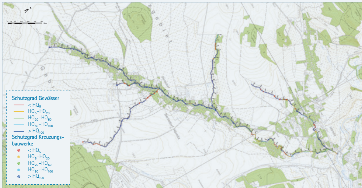
Abbildung 9-73: Bestehender Schutzgrad (IST- Zustand) (Quelle: Sieker 2012)
