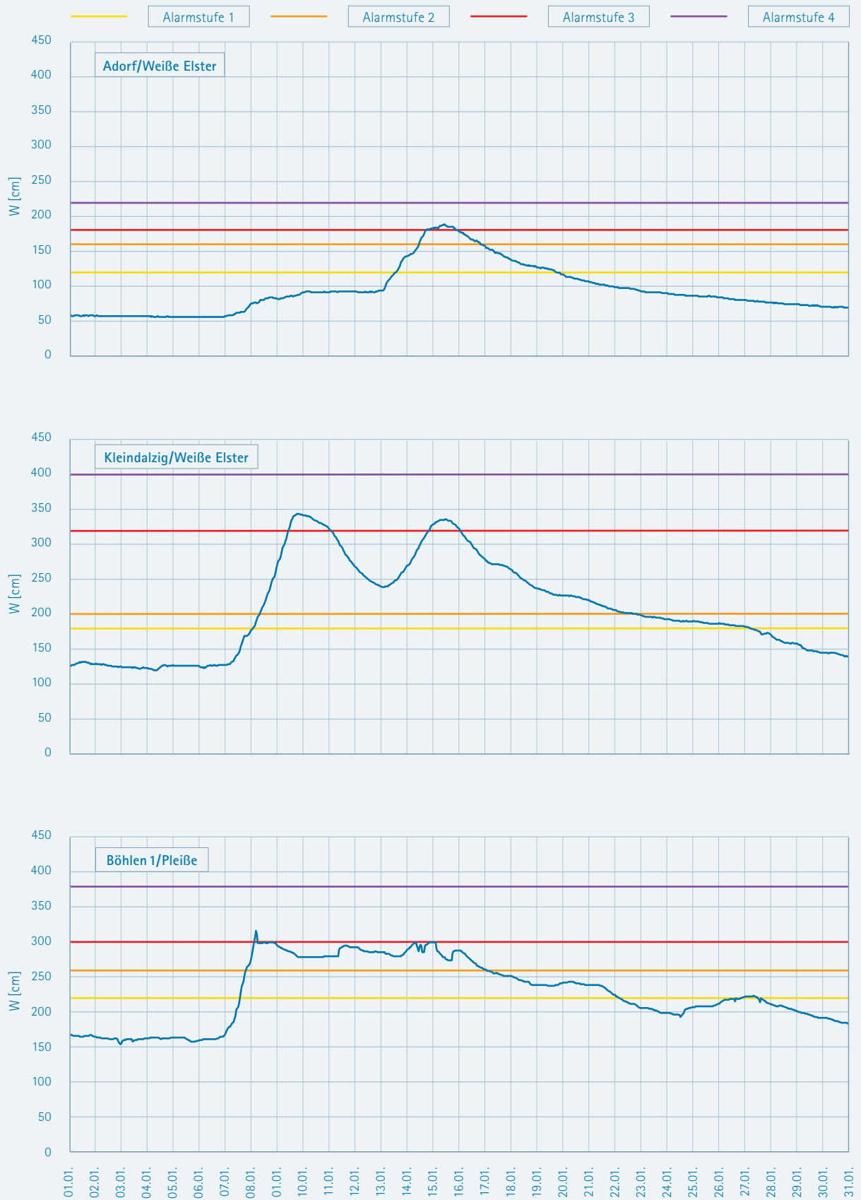
Abbildung 4-60: Wasserstandsganglinien mit entsprechenden Richtwerten der Alarmstufen 1-4 der sächsischen Hochwassermeldepegel Adorf und Kleindalzig an der Weißen Elster und Böhlen 1 an der Pleiße für den Zeitraum 01.01.-31.01.2011
