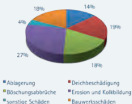
Abbildung 7-9: Die prozentuale Verteilung der erfassten Schadenstypen an den durch das Hochwasser im Januar 2011 verursachten Schadensstellen (Datengrundlage: Schadenserfassung der LTV)
