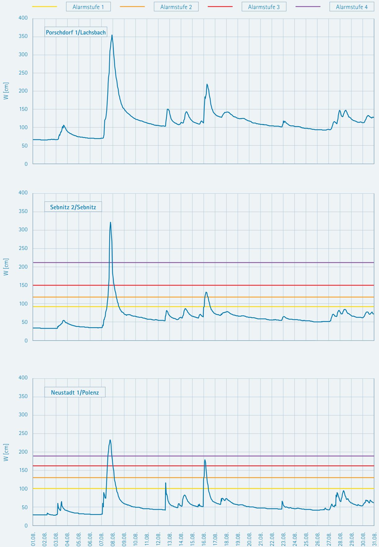
Abbildung 4-22: Wasserstandsganglinien mit entsprechenden Richtwerten der Alarmstufen 1-4 an den Pegeln im Gebiet des Lachsaches für den Zeitraum 01.08.-31.08.2010
