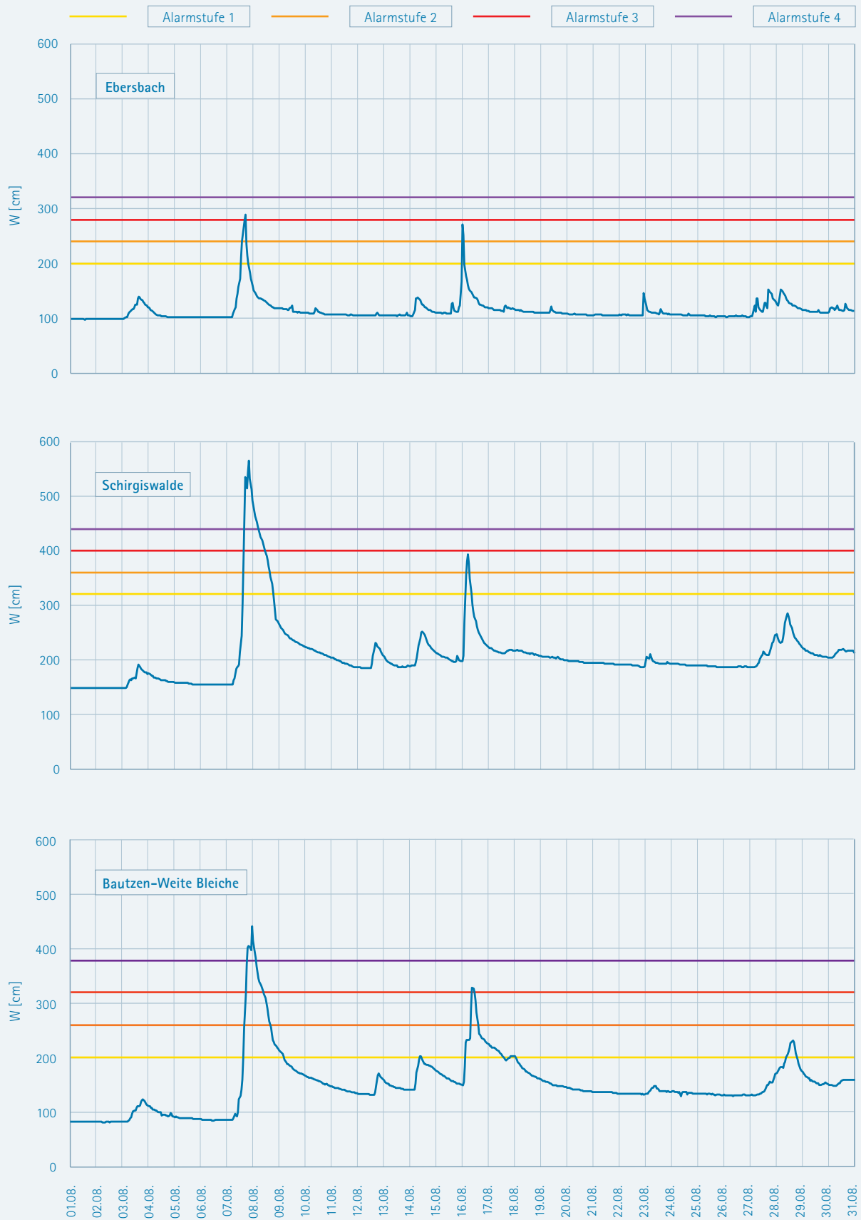
Abbildung 4-45: Beobachtete Wasserstandsganglinien mit den entsprechenden Richtwerten der Alarmstufen 1-4 an den Pegeln an der Spree oberhalb der Talsperre Bautzen für den Zeitraum 01.08.-31.08.2010
