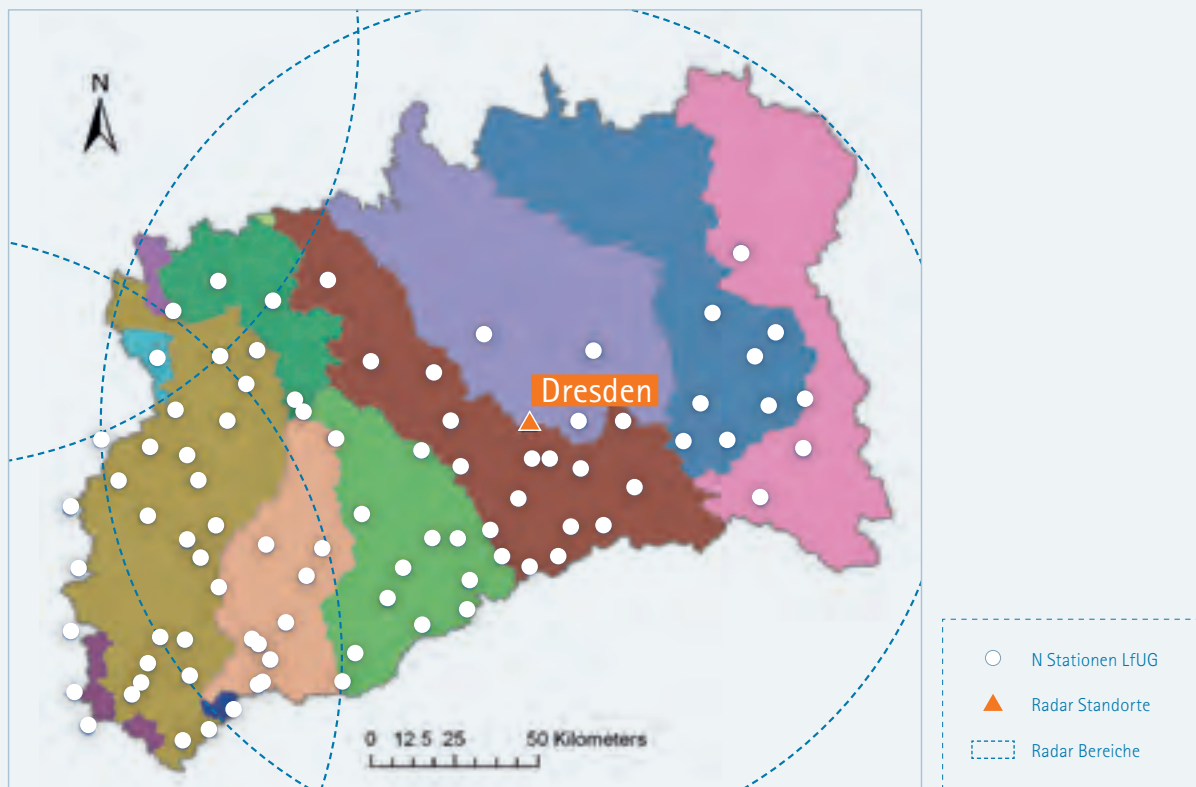
Abbildung 3-9: Untersuchungsgebiet, Niederschlagsstationen, Radarstandorte und Teileinzugsgebiete entsprechend der dreistelligen Gewässerkennzahl (Haberlandt 2011)
