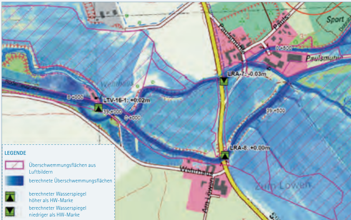
Abbildung 5-3: Vergleich der modellierten Überschwemmungsflächen des Ereignisses im September 2010 mit den aus Luftbildern erfassten Überschwemmungsflächen und den eingemessenen Hochwassermarken. (Quelle: Koban & Schuckert Ingenieurpartnerschaft 2012a)
