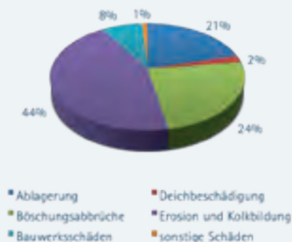
Abbildung 7-7: Die prozentuale Verteilung der erfassten Schadenstypen an den durch die Hochwasserwellen im August und September 2010 verursachten Schadensstellen (Datengrundlage: Schadenserfassung der LTV)
