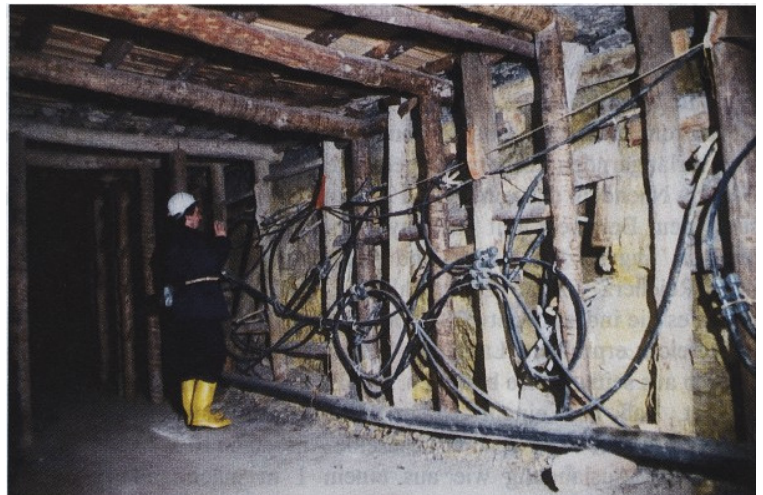
Abb. 167: Strecke zur Aufgabe der Säurelösung in den Gewinnungsblock 3137/+94 m-Sohle. Die Lösung wird aus Schläuchen in den durchbohrten Block gepreßt. Foto: J. KUGLER, 1996
