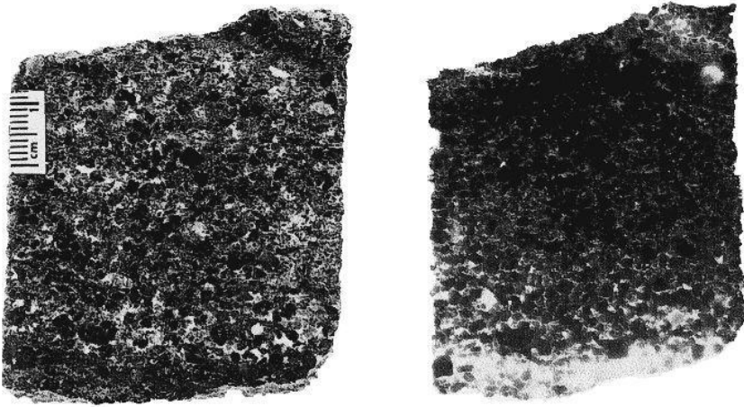
Abb. 62: (links Gestein, rechts Radiographie): Erzfeld Pirna, Bahra-Kirchberger Zuflußsenke, Quarzsandstein, grobkörnig, hellgrau, kaolinit- ischer Zement, Flußauenschich- ten (ctr 2 ), Bohrung 2110/79, Teu- fe 229,5 m, Probe 13
