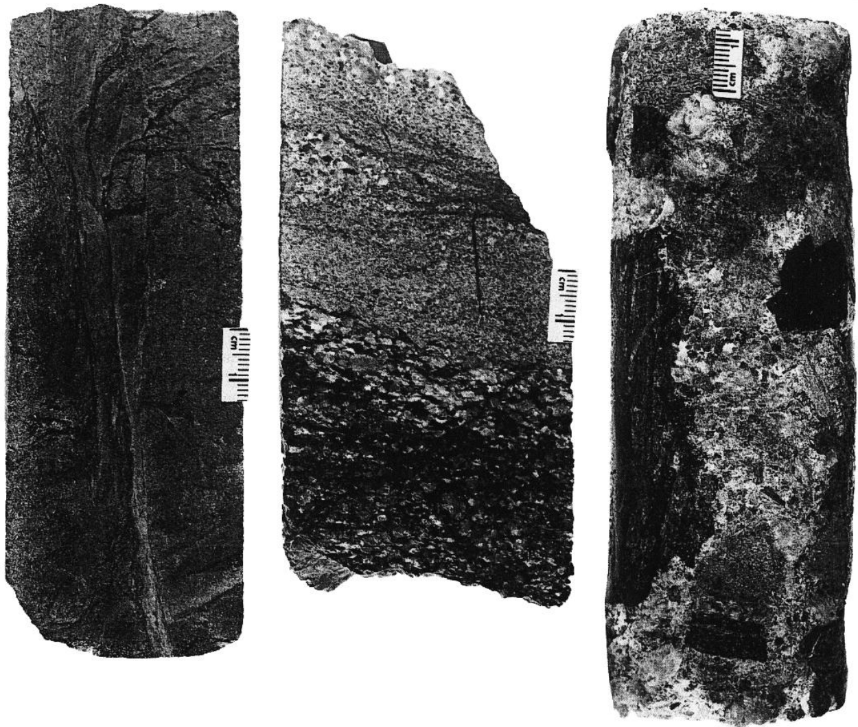
Abb. 6 (links oben): Silifizierter und zerklüfteter Unterquadersandstein an der Lausitzer Überschiebung; Bohrung 2403/81, Teufe 468,2 m.
