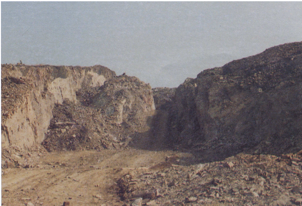
Abb. 120a und 120b: Gewinnung von Versatzmaterial aus Tagstrossenbauen auf dem Sauberg
