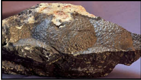
Abb. 2-5-27: Schalige Aggregate von ged. Arsen, so genannter Scherbenkobalt, mit Dolomit-Ankerit (Sohle -990 m, Str. 1401, Bildbreite 22 cm)
