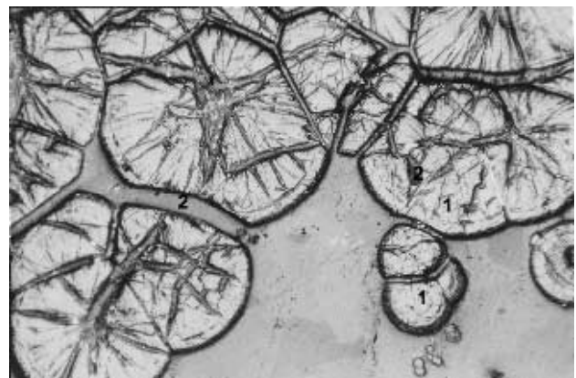
Abb. 2-5-11: Pechblendesphärolithe (1) in Calcit (2); (Sohle -990 m, Str. 9/ Qu. 1406, Vergrößerung 50x)
