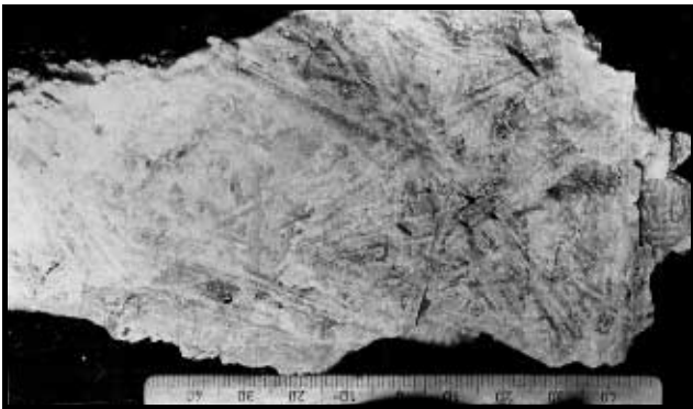
Abb. 2-5-23: Pseudomorphose von Quarz nach Baryt, so genannter Kastenquarz, vom „Roten Kamm“, Sohle -240 m
