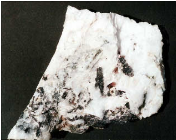
Abb. 4-2-9: Wolframit mit Scheelit in Quarz (Sohle -1530 m, F.Str. 2000, Bildbreite 22 cm)
