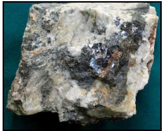
Abb. 2-5-2: Milchquarzgang der kb-Formation mit Galenit, Sphalerit und wenig Chalkopyrit von Gang „Erna“, Sohle -720 m, Qu. 1102 SE (Bildbreite 15 cm)
