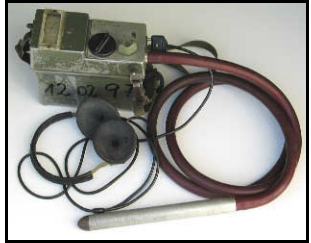
Abb. 2-8-2: Der Szintillations-Zähler „Unirad-Z“ - seit den 70er Jahren als universelles radiometrisches Messgerät im untertägigen Einsatz
