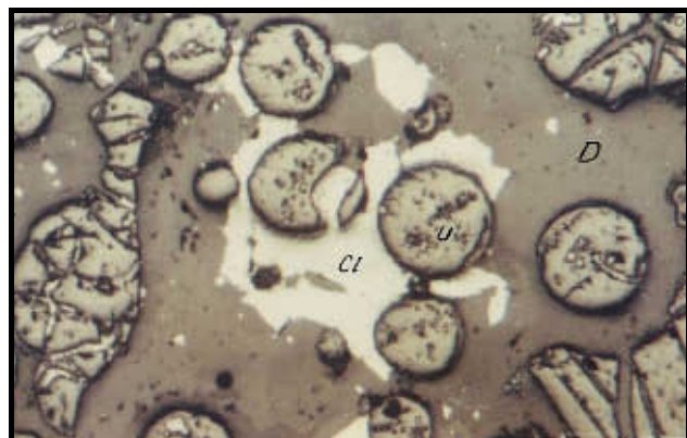
Abb. 2-5-19: Pechblendekügelchen (U) mit Clausthalit (Cl) in Dolomit (-1305-m-Sohle; Qu. 1751 bei 196,4 m; Vergrößerung 130x)
