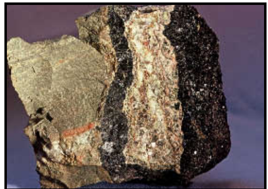
Abb. 2-5-16: Stinkspat am Salband eines Dolomitganges im Metadiabas (Sohle -480 m, Gang „Magdeburg“, Bildbreite 16 cm)
