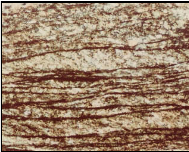
Abb. 2-3-20: Graphitischer Glimmerfels im Dünnschliffbild (Sohle -1620 m, Qu. 2108 bei 382 m; Vergr. 50x; N+)
