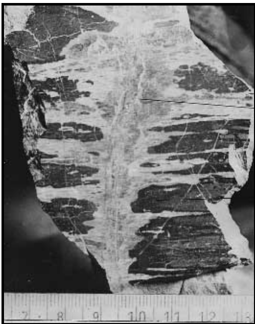
Abb. 2-3-24: Von einem Trum ausgehende Verskarnung im Metadiabas (Zentralfeld Oberschlema, -480-m-Sohle, Gangbereich „Bergmanns Segen“)
