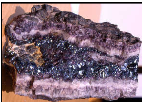
Abb. 2-5-9: Kammquarzgang mit Specularit im Zentrum (Gang „Ehrentraut“, Sohle -420 m; Bildbreite 18 cm)
