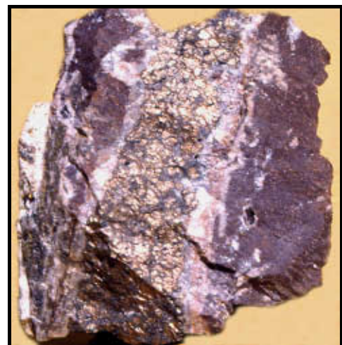
Abb. 4-2-2: Nickelin mit Quarz von Oberschlema (Schacht 6, -390-m-Sohle, Str. 25/Qu. 63; Bildbreite 10 cm)
