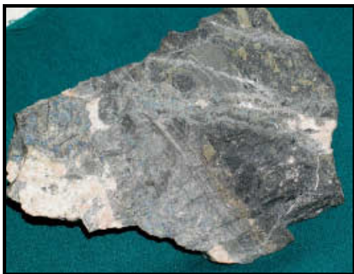
Abb. 2-5-34: Pechblende in Löllingit mit Dolomit-Ankerit aus der Ostflanke, Sohle -1440 m, Block 8044 (Bildbreite 18 cm)
