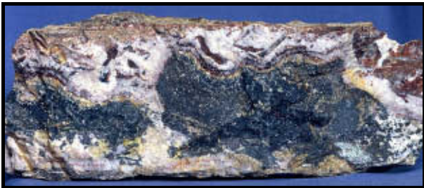
Abb. 2-5-33: Gangstufe der biconi-Formation mit Skutterudit, Siderit und Kammquarz-Relikten in Dolomit-Ankerit (genauer FO unbekannt, Bildbreite 28 cm)
