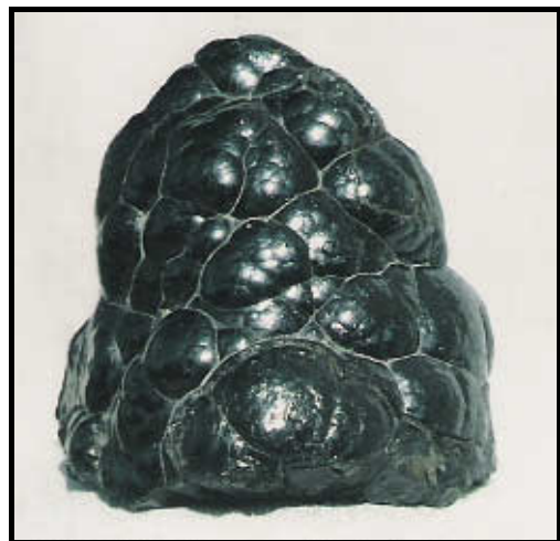
Abb. 2-5-40: Typische Pechblende der kku-Formation von Sohle -675 m; Gang „Union“/„Erna II“ (Bildbreite 8 cm)
