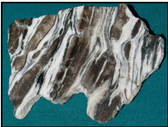
Abb. 2-3-9: Boudinierter Kalk vom Qu. 1211 SW / Sohle -810 m (Bildbreite 18 cm)
