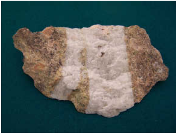
Abb. 2-5-1: Milch- und Fettquarz bilden einen Gang im Granit, Sohle -540 m, Qu. 908 b (Bildbreite 16 cm)
