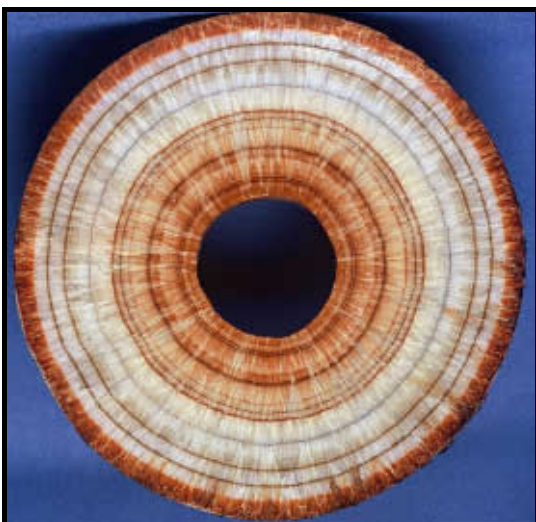
Abb. 2-5-38: Kalksinter als rezente Bildung aus einer Rohrleitung von der Sohle -1125-m zur -1305-m-Sohle im Schacht 382 (Bildbreite 16 cm)
