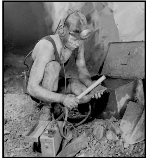
Abb. 3-6-3: Hauer bei der Vor-Ort-Sortierung des Erzes mit Hilfe eines Radiometers
