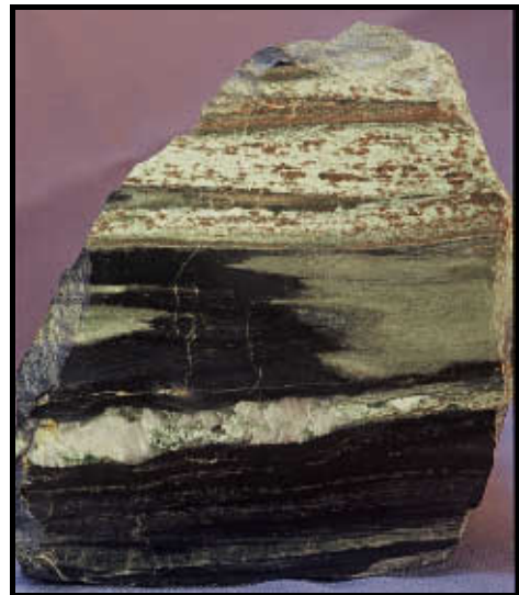
Abb. 2-3-21: Lagig verskarnter Metadiabas mit Granat, Pyroxen, Epidot und Wollastonit (Bildhöhe 18 cm)
