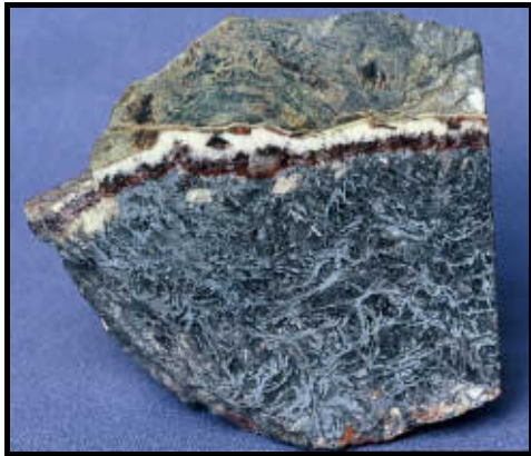
Abb. 2-5-32: Dendriten von ged. Wismut, eingebettet in Gips, mit Dolomit-Ankerit am Salband von Sohle -720 m, Str. 14c/F.-Str. 1098 (Bildbreite 10 cm)
