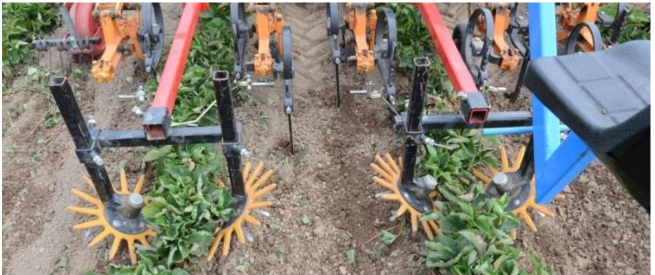
Abbildung 9: Arbeitsweise der Hackschare (Fahrgasse) und Fingerhacken (Pflanzreihe), Variante A
