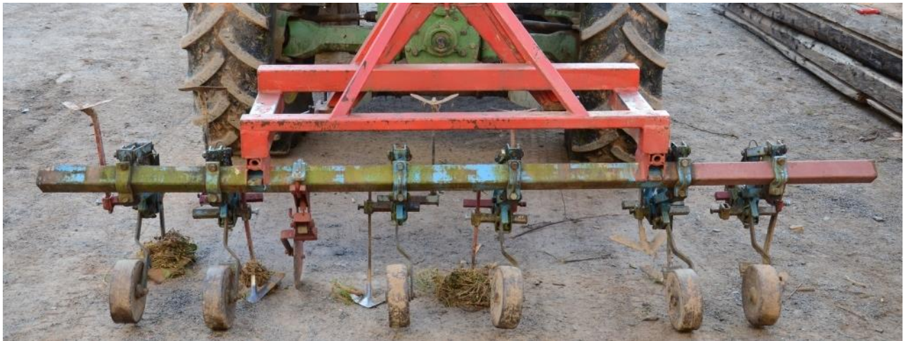
Abbildung 3: Praxisübliche Technik zur mechanisierten Unkrautregulierung, nur geeignet für Bearbeitung der Fahrgassen
