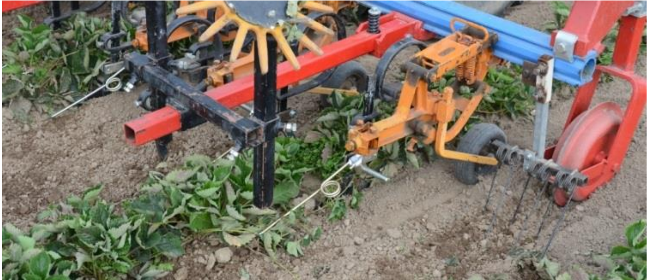
Abbildung 10: Arbeitsweise der Torsionshacken in der Pflanzreihe, Variante B
