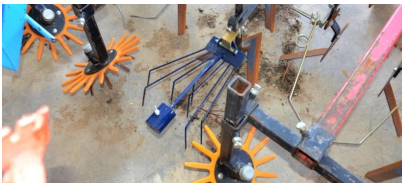
Abbildung 7: Reihenstriegel hinter den Gänsefußscharen verbesserten in den Fahrgassen die Wirkung beim Herausreißen auch schon etwas größerer Unkräuter. Der Anbau erfolgt am Stiel der Hackschare.
