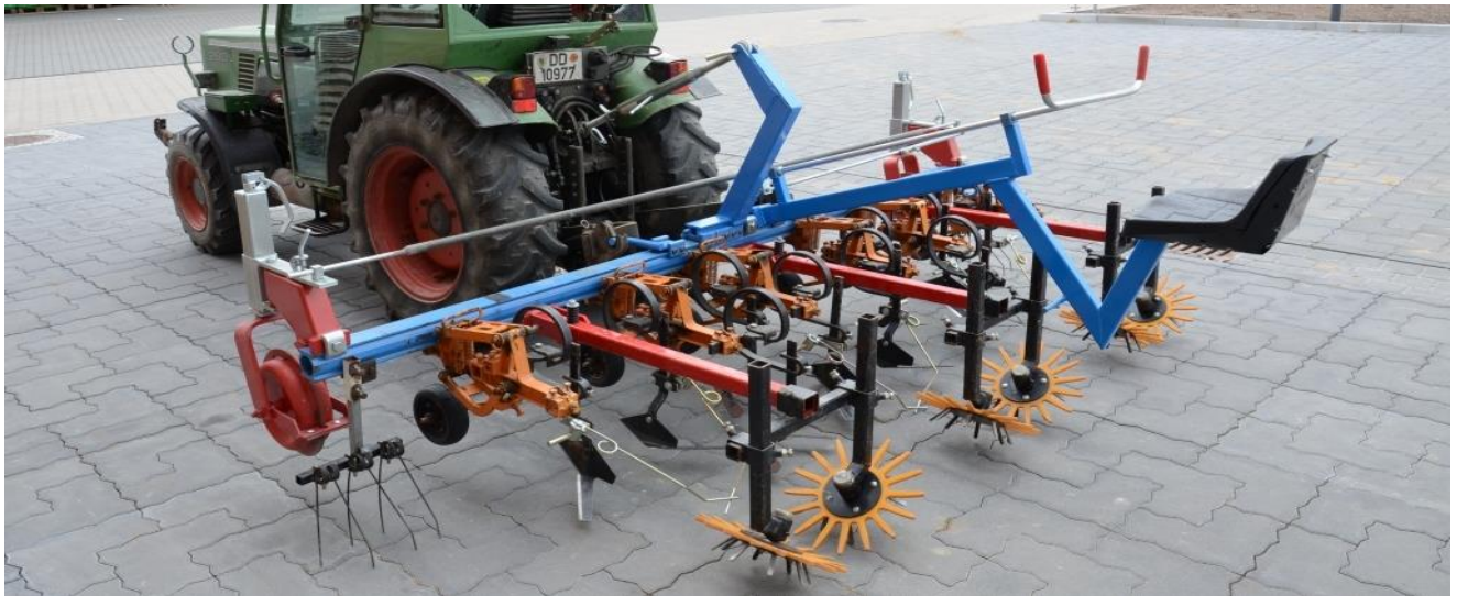
Abbildung 4: Hackrahmen (Modell Kress Argus Präzisionshacke) mit manueller Handsteuerung im Heckanbau
