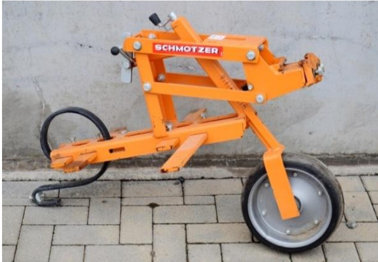
Abbildung 8: Das etwas größere Kombi-Parallelgramm (Fa. SCHMOTZER) könnte eine mögliche Alternative zum im Versuch eingesetzten Mehrzweckparallelgramm sein. Hier wäre pro Fahrgasse nur 1 Stück notwendig. Es können bis zu 5 kleinere Hackscharen angebaut werden. Die im Versuch verwendeten Rankenschneider der gleichen Firma können hier direkt angebaut werden (ohne selbst gebaute Eigenkonstruktion).
