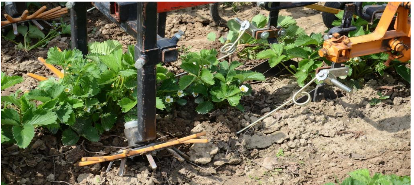
Abbildung 11: Kombination von Torsionshacke (rechts) und Fingerhacke (links), Variante D
