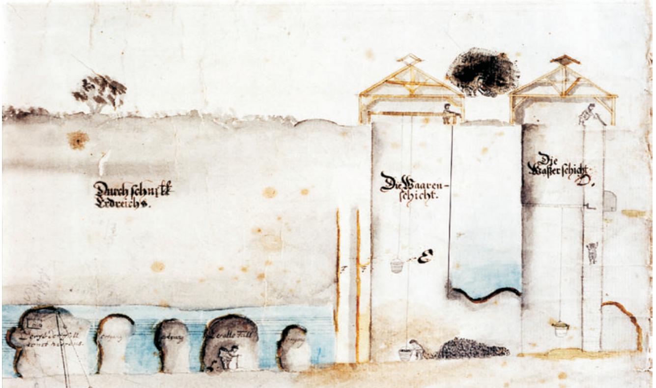
Abb. 9.2-2: Querschnittsdarstellung der „Herrschaftlichen Kohlenbaue zu Burgk“ von 1774 mit einem Waaren- und Wasserschacht und dem Anschluss an einen Stollen = „Alter Schacht“ der Burgker Steinkohlenwerke. Besonderheiten: links das Tiefe Fallort mit Linien (Markscheiderzug oder Seilzug?), mehrere Weitungsbaue ohne Ausbau, im „Alten Fall“ Kohlehucker, am Waarenschacht ausgekippte Kohle, die am „Füllort“ in Tonnen gefüllt, durch Haspel gefördert und mit Karren zum Stapel gefahren wurde. Im Wasserschacht nur ein Kübel am Haspelseil, rechts vom Haspel die „Hornstatt“ für das Haspelhorn und zum Auskippen in einen Stollen. Daneben der Fahrschacht mit „Fahrten“ und Verschlussdeckel. Original Slg. SSB
