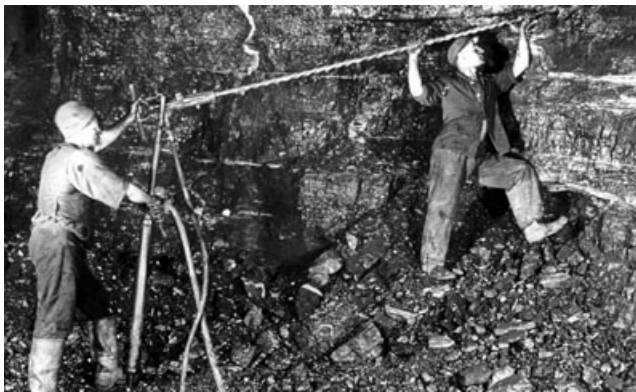
Abb. 14-17: Bohren mit Pressluft-Bohrstütze und Schlangenbohrer für Kohle im 1. Flöz (Große Lette rechts oben). Schacht 2 (Unt. Revier) 1950; Foto: Deutsche Fotothek Nr. 104425
