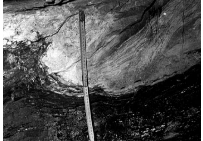
Abb. 3.2-49: Hakenartige Aufpressung der Hangendschichten des 2a Flözes durch gleitbrettartige Rutschung. Döhlen-Formation, Paul-Berndt Grube, 13. Sohle, Qu. West, nahe 13. Hauptstrecke, Foto: REICHEL
