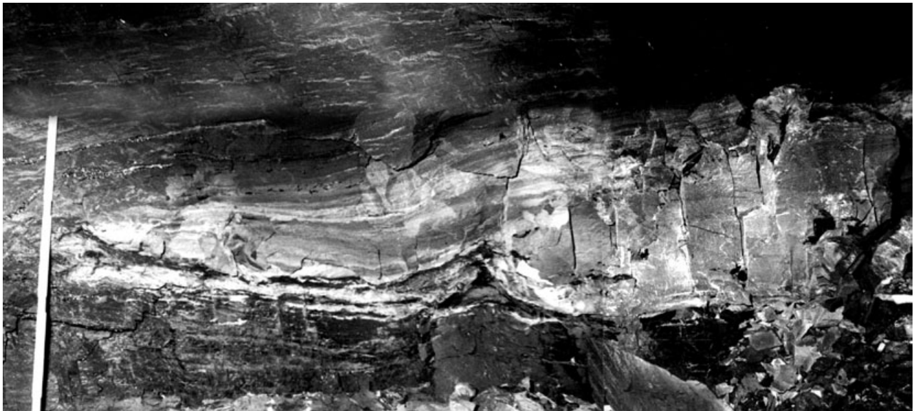
Abb. 3.2-9: „Bergschuss“ - Große Lette des 1. Flözes als Bergemittel (Arkose) mit deutlicher Schichtung und bankrechten Calamiten, Transportrinne. Döhlen-Formation, 1. Flöz, Paul-Berndt-Grube, 13. Sohle, Gf. Kaiser Schacht, Streb 23; Foto: REICHEL
