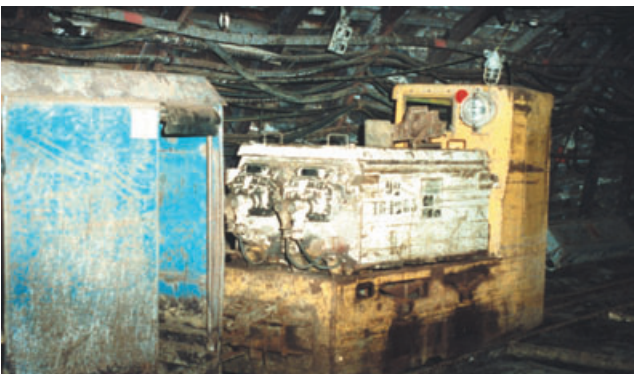
Abb. 10-20: Akkulokomotive vom Typ EL 9 mit Mannschaftswagen Füllortbereich Schacht 1 Dresden-Gittersee; Foto: SCHÜLER
