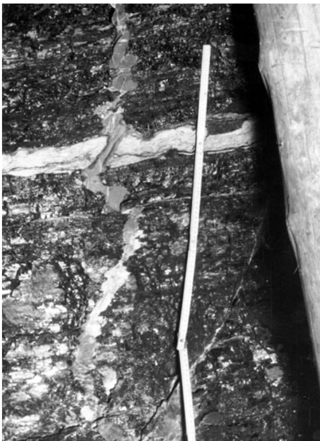
Abb. 3.2-10: Glanzstreifenkohle im Niveau Große Lette. Döhlen-Formation, 1. Flöz, Bildmitte typisch verzahnter Kamm = klastischer Gang mit Lamination im Bereich der Lette, P-Berndt-Grube, Streb 35/9 bei 5 m; Foto: REICHEL
