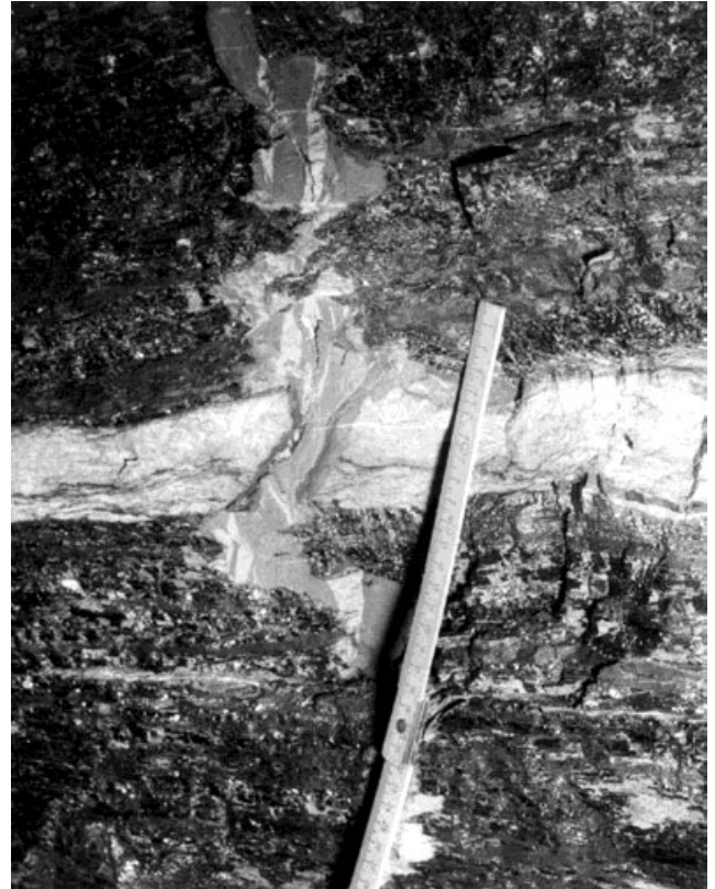
Abb. 6-3: Klastischer Gang oder „Kamm“ mit typischer Verzahnung zum Kohlenflöz. Im Bereich der hellen Lette Fließgefüge, oben und unten plastische Deformation durch Kompaktion der Kohle. Döhlen-Formation, 1. Flöz, Große Lette, Paul-Berndt Grube, Gf. Kaiser Schacht, Streb 35/9 bei 5 m; Foto: REICHEL
