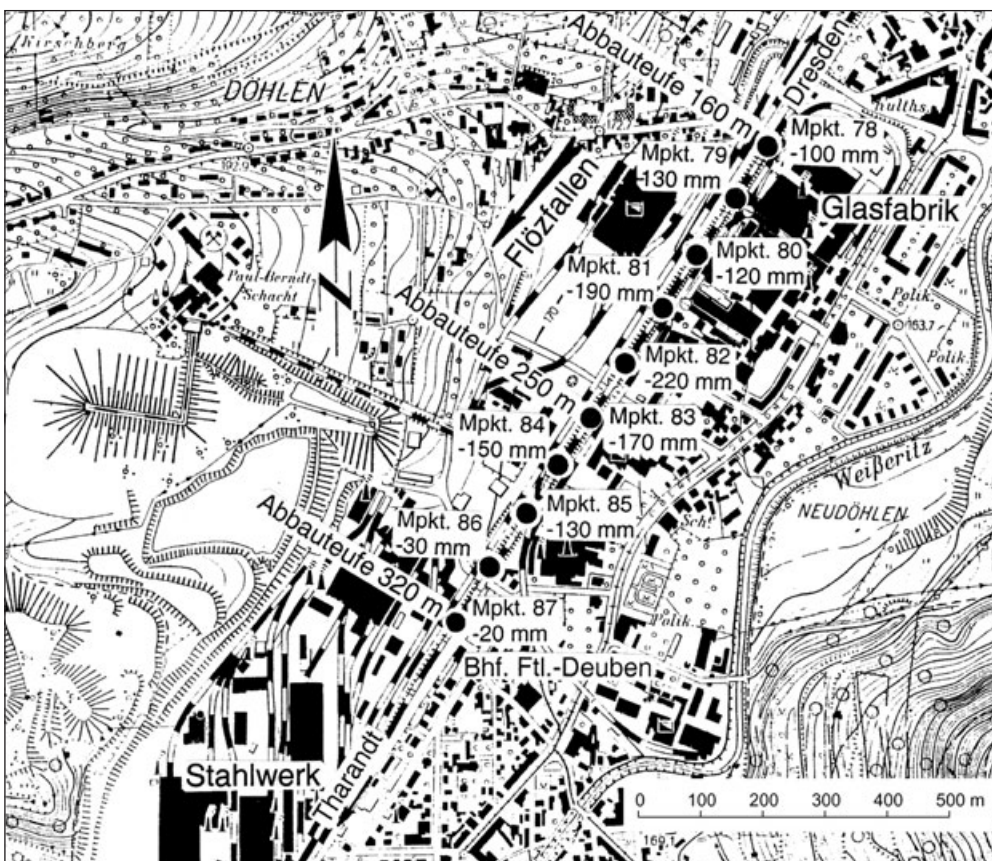
Abb. 14.7-1: Vom Steinkohlenbergbau verursachte Bodensenkungen im Bereich der Eisenbahntrasse, Ermittlung der Messpunkt (Mpkt.)-Angaben zwischen 1894 und 1904 nach HAUSSE 1907, Kartengrundlage: Tageriss - 1958; Bearbeiter: SCHAUER 2004
