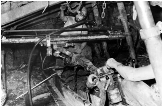
Abb. 10-15: Bohrgeräteträger im Abbau; Foto: SDAG Wismut
