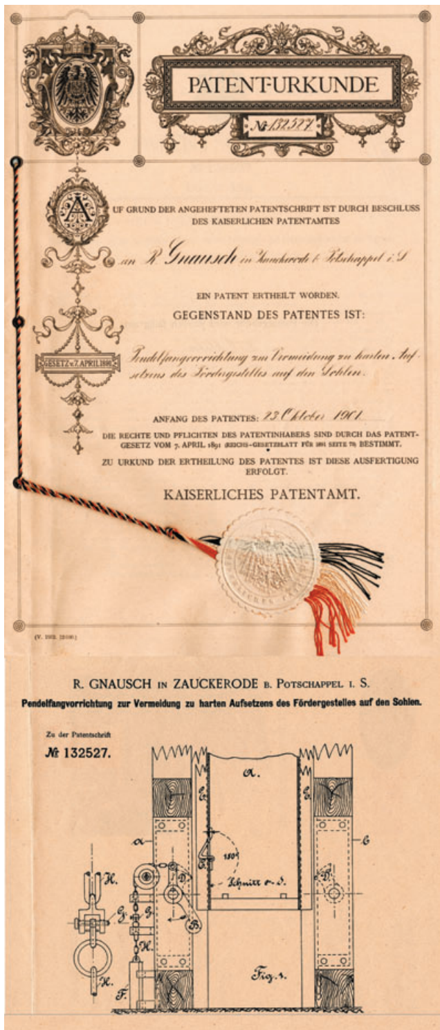
Abb. 14.4-8: Patenturkunde und Zeichnung (Seitenansicht) zur Patentschrift „Pendelfangvorrichtung zur Vermeidung zu harten Aufsetzens des Fördergestells“ für R. GNAUSCH, Königl. Steinkohlenwerke; Original SSB
