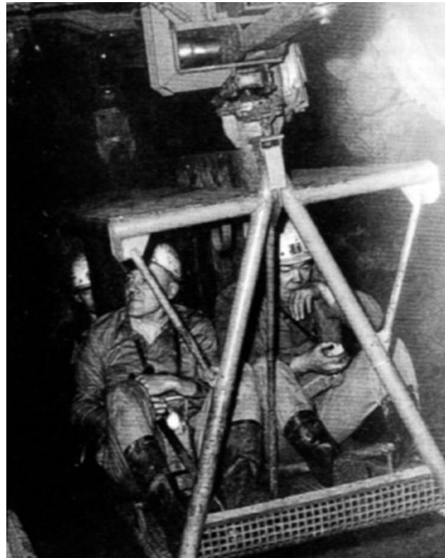
Abb. 10-22: Steigorttransporteinrichtung (Einschienenhängebahn) für Lasten- und Personentransport, Gstbg. 930 Gf. Bannewitz-Nord; Foto: SDAG Wismut (MAI et al. 1999: 50)
