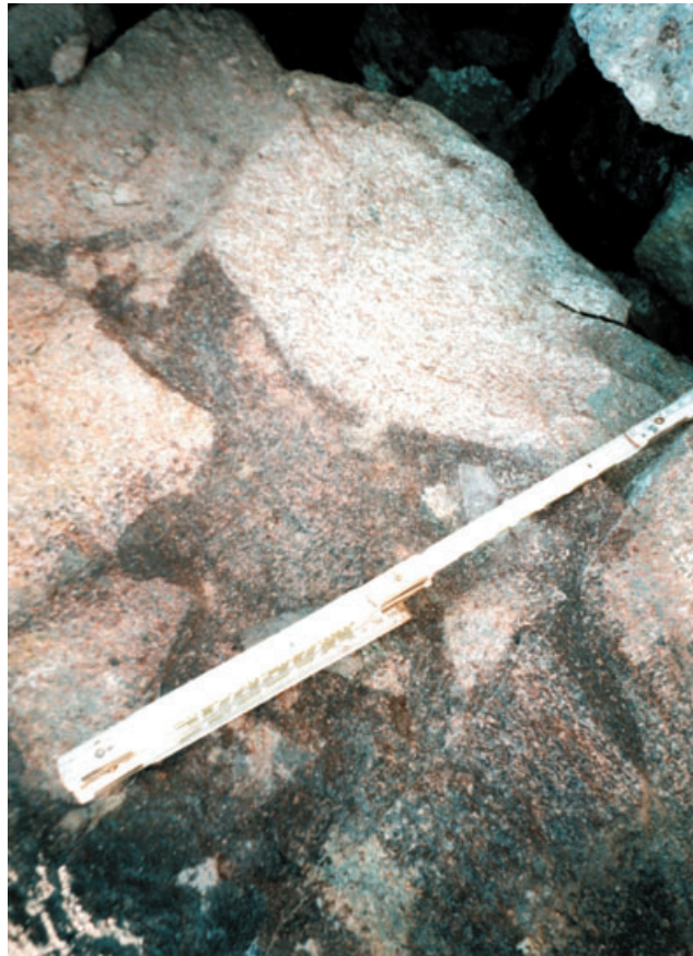
Abb. 3.1-2: Basalkonglomerat der Unkersdorf-Potschappel-Formation, Monzonit und Felsitporphyr in Bildmitte, Autobahntunnel Dresden-Coschütz, Haldenfund, verm. von Station 1446 m; Foto: REICHEL
