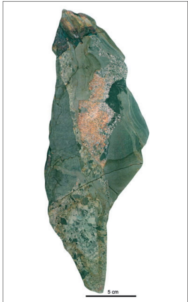
Abb. 6-14: Bruchstück eines Kammes (Klastischer Gang) mit Fluidalschichtung und Brekzienpartien, Niveau 2./2a-Flöz, Freital Zauckerode; Kontaktkopie H. WALTER März 1997
