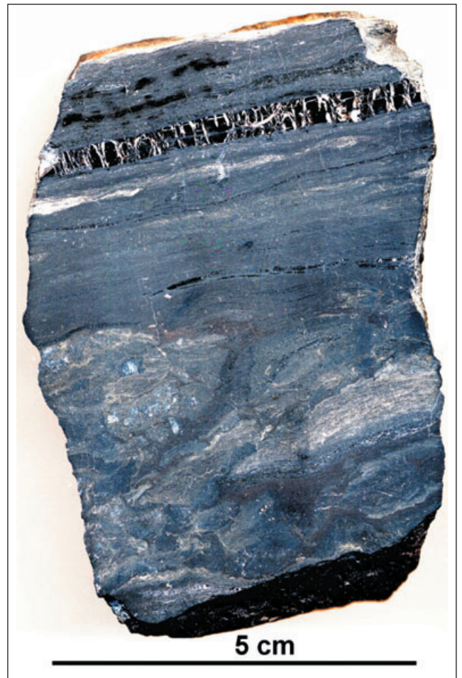
Abb. 4-6a: Anschliff eines uranvererzten Brandschiefers mit turbulent abgelagertem Material im unteren Teil und schichtigem Brandschiefer mit Vitrinitlage im oberen Teil des Anschliffes, 5. Flöz-UB, Str. 5428-01, Gf. Bannewitz-Nord
