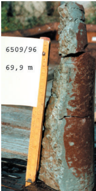
Abb. 7-2: Steilgeklüfteter Silt (kluftparallel gebleicht), Untere wechselhafte Bänke der Bannewitz-Hainsberg-Formation, Bhrg. HG 6509/96, Teufe: 69,9 m, Kern Ø: ca. 100 mm; Foto: SCHAUER
