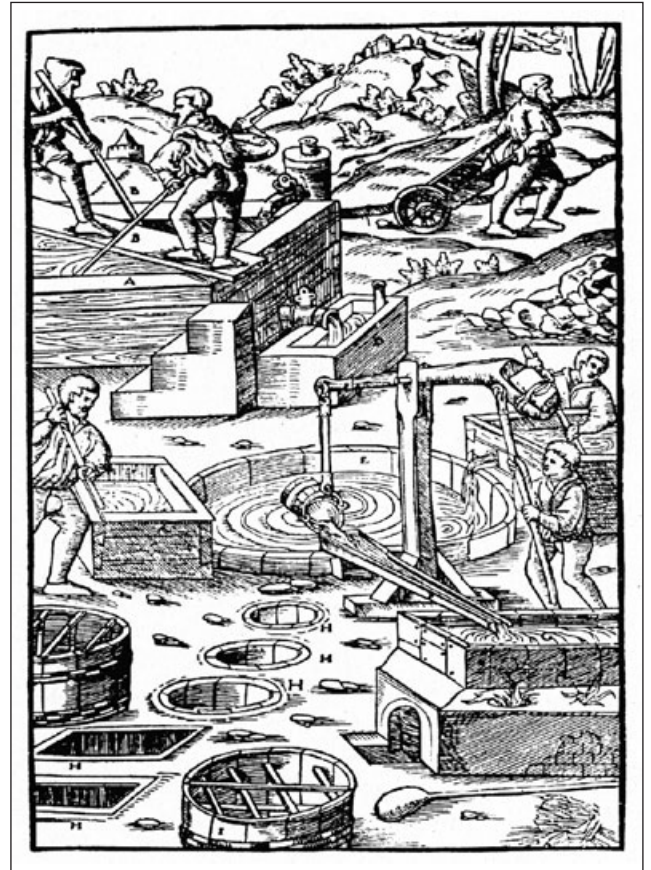
Abb. 13-1: AGRICOLA, Darstellung der Laugung (Leaching) in einem Behälter (A) der Siedewanne aus Blei (G) und den Kristallisationsbottichen (H)
