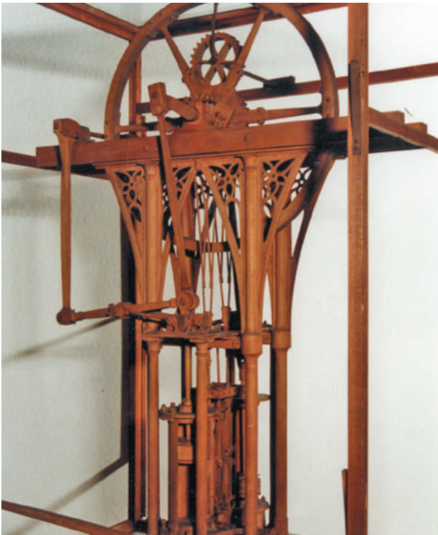
Abb. 14-6: Funktionsmodell der in der Maschinenbauanstalt Halsbrücke gefertigten Zweizylinderdampfmaschine für die Königl. Steinkohlenwerke. Modellsammlung der TU BA Freiberg, kleines Modell SSB; Foto: Hochschulbildstelle TU Bergakademie Freiberg
