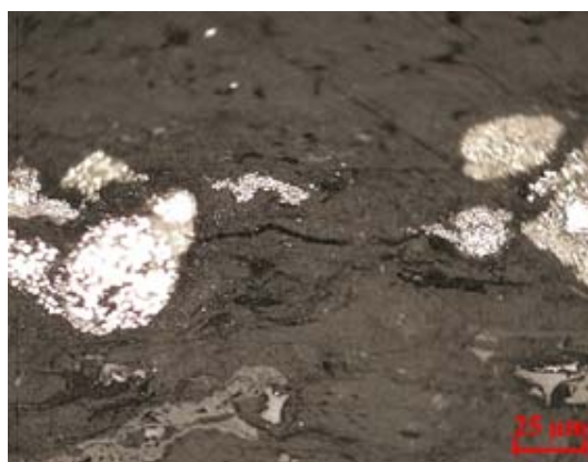
Fig. 6: Pyrit-Framboide (kaviarähnliche \text{FeS}_2 -Agglomerate) in toniger Matrix (dunkel); eingelagert sind isolierter Vitrinit-Splitter (mittelgrau); Hangendes des Zachkohlenflözes
